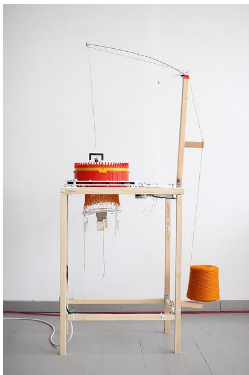
Figura 6: macchinario open hardware per il Circular Knitic.
