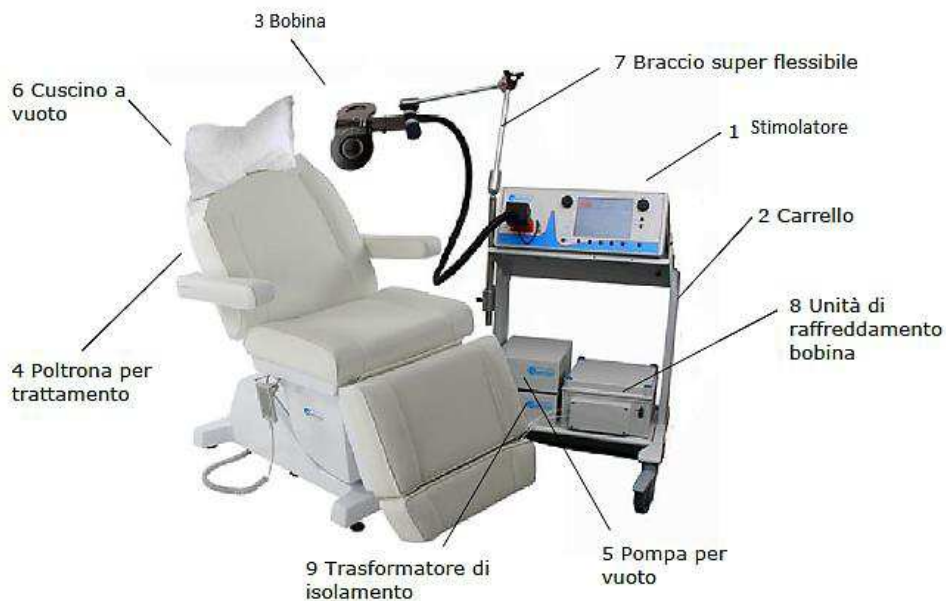
Figura 7. L'immagine rappresenta uno stimolatore TMS con i vari dispositivi utili al trattamento (Fonte: adattato da Tonica Elektronik A/S, 2015).
