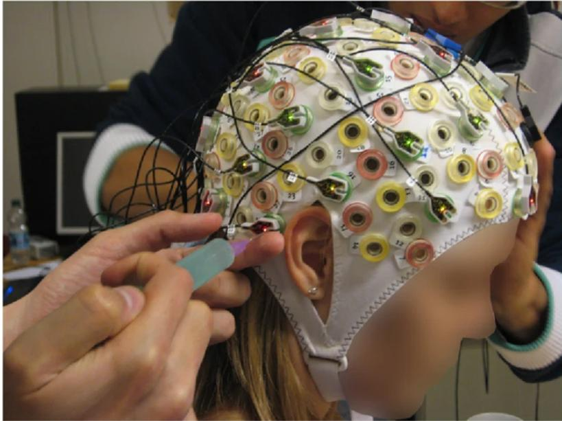
Figura 2.11: Sistema EEG a 32 elettrodi usato durante l'acquisizione dati (figura tratta da [22] ).
