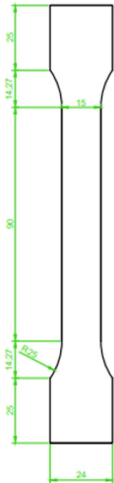
Fig. 6. Geometria provino a osso di cane
