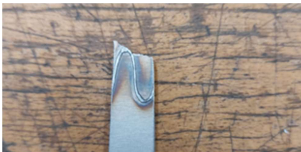
Fig. 20. Provini rettilinei dopo rottura
