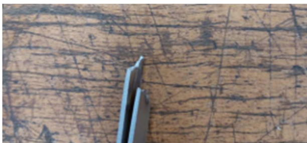
Fig. 21. Provini sinusoidali dopo rottura
