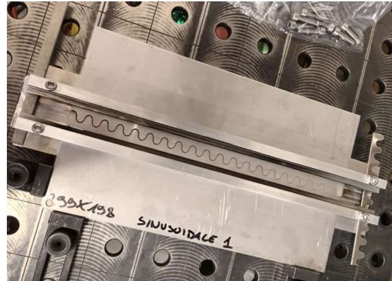
Fig. 12. Clampaggio saldatura laser 2
