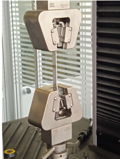
Fig. 14. Provino inserito nel macchinario di prova
