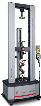
Fig. 13. Macchinario utilizzato nella prova a trazione
