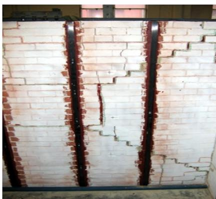
Fig. 3-7 Fessurazione in seguito a compressione verticale
