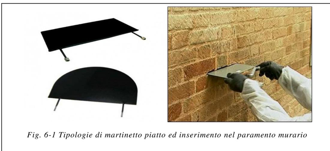
*Fig. 6-1 Tipologie di martinetto piatto ed inserimento nel paramento murario*
