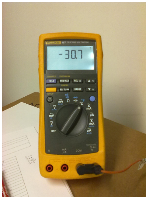
Figura 3.4: Lettura della temperatura sul multimetro dopo il raggiungimento di -30^{\circ}\text{C}
