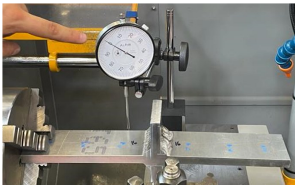
Figura 3.3.7: Prima verifica deformazioni interne allo strumento, ritorno a zero del comparatore in aria.
