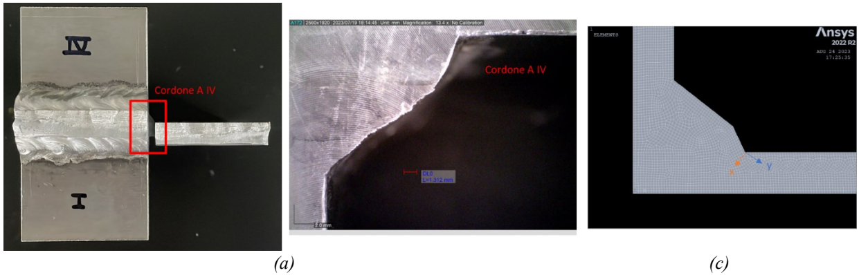
Figura 7.4.3: Esempio 2 di Analisi FEM sulla geometria locale del provino T27.
