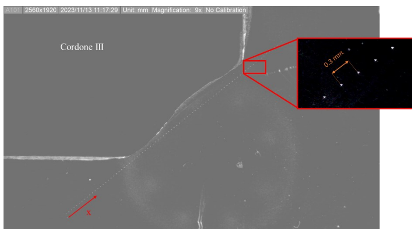
Figura 3.4.3: Path utilizzato per le misure di microdurezza con ingrandimento effettuato per evidenziare il passo di misura di 0.3 \text{ mm} .
