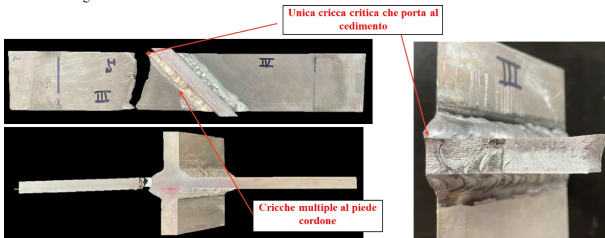
Figura 6.2.1: Esempio di cricca critica che porta al cedimento per i provini Inclined VA dove sinotano gli inneschi multipli al piede cordone. Provino I2 VA, R=0 , \Delta F_{max} = 125kN .
