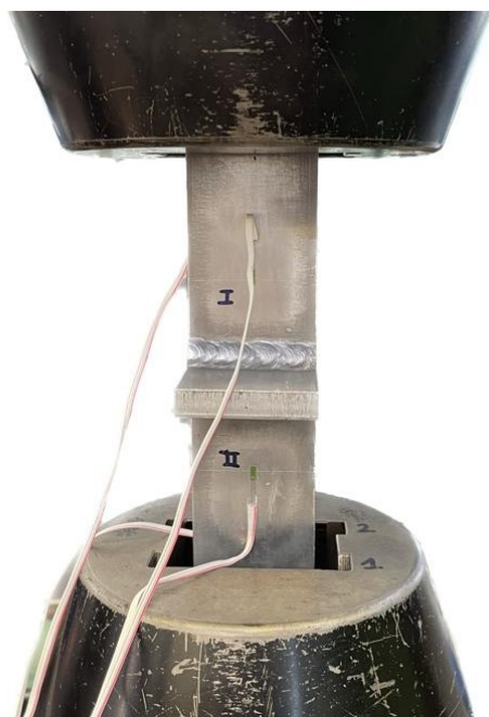
Figura 4.2.2: Provino estensimetro montato in macchina nella configurazione A.
