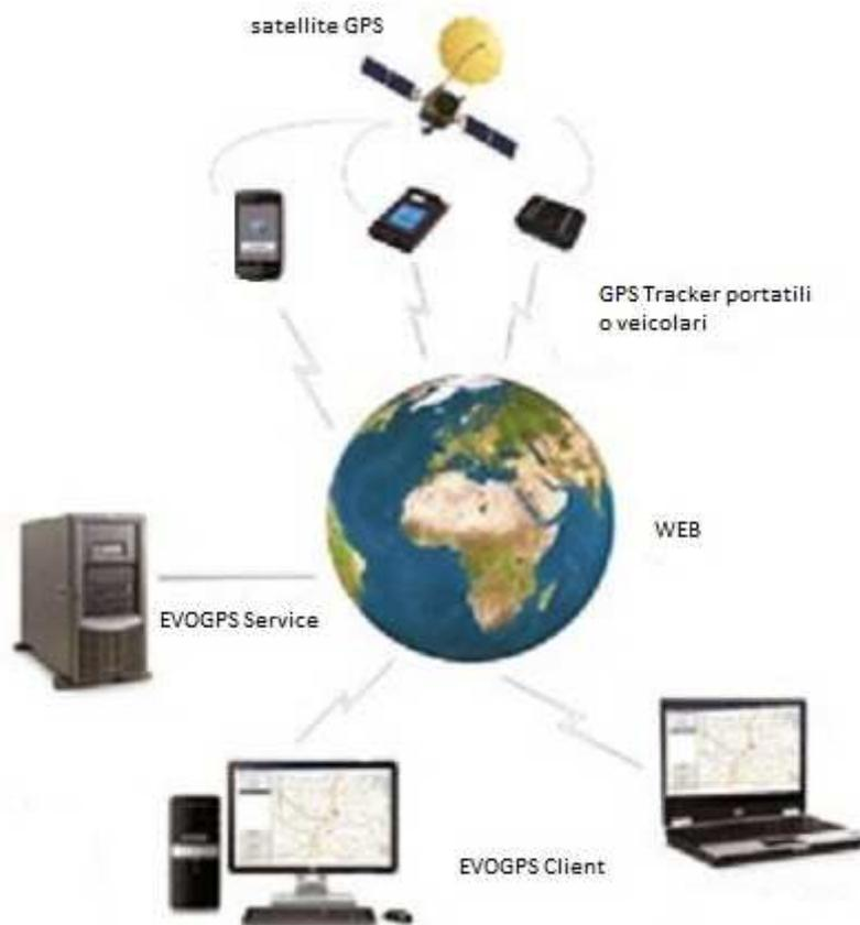
Figura 1: schema funzionamento EvoGPS-Web
