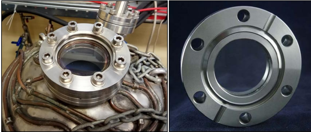
Figura 3.4: finestra in cordial presente sulla campana. A sinistra la finestra che permette al pirometro di rilevare le temperature all'interno della camera.
