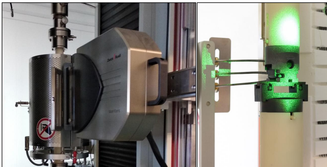
Figura 5.47: laser extensometer utilizzato per la misura degli spostamenti del provino.
