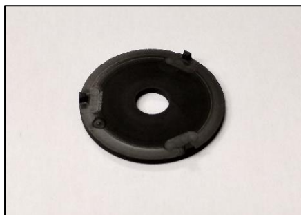
Figura 4.36: schermo termico in grafite POCO EDM-3 ® .
