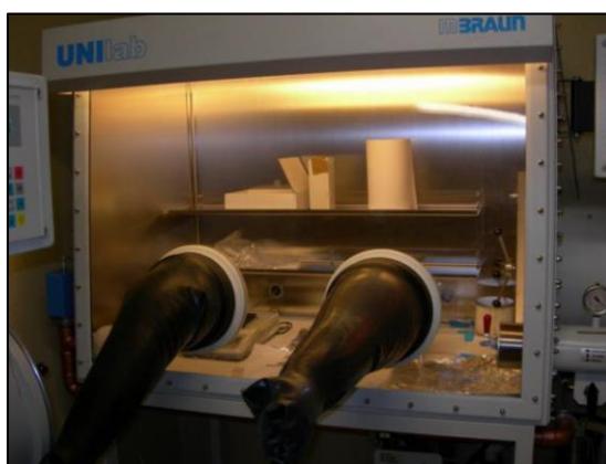
Figura 2.12: glove box utilizzata per lavorare ed immagazzinare i composti di uranio.
