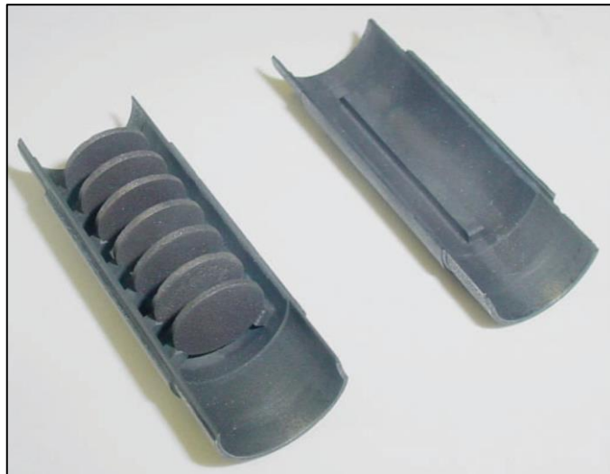
Figura 2.14: i 7 dischi in carburo di uranio all'interno di un primo prototipo di graphite box dopo il test online agli ORNL.
