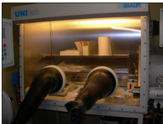
Figura 6.1: glove box presente ai Laboratori Nazionali di Legnaro utilizzata per la produzione di UC_x .
