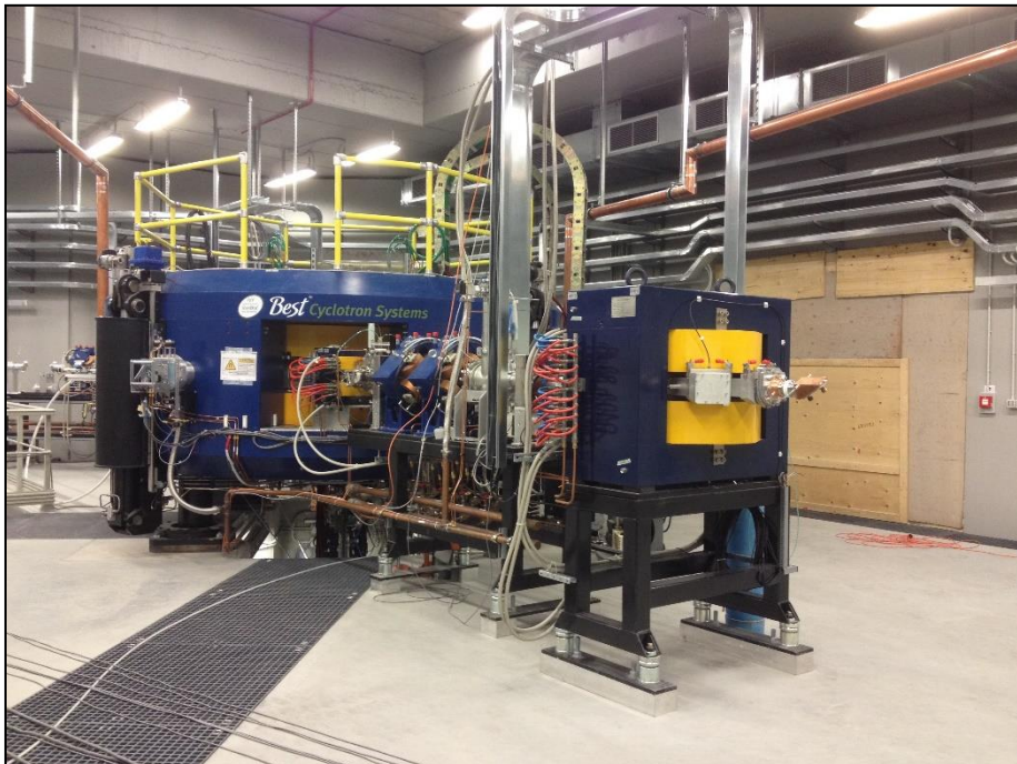
Figura 1.12: fotografia del ciclotrone BEST 70p sviluppato dalla Best Cyclotron Systems, Inc. presente all'interno della facility SPES ai Laboratori Nazionali di Legnaro.
