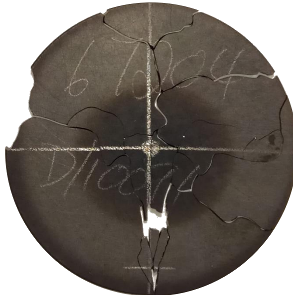
Figura 4.34: foto del disco condotto a rottura grazie all'implementazione della seconda versione dello schermo termico in tantalio.
