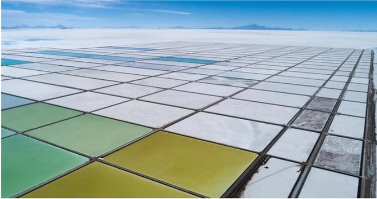
Figura 24 - Litio estratto da saline per evaporazione solare
