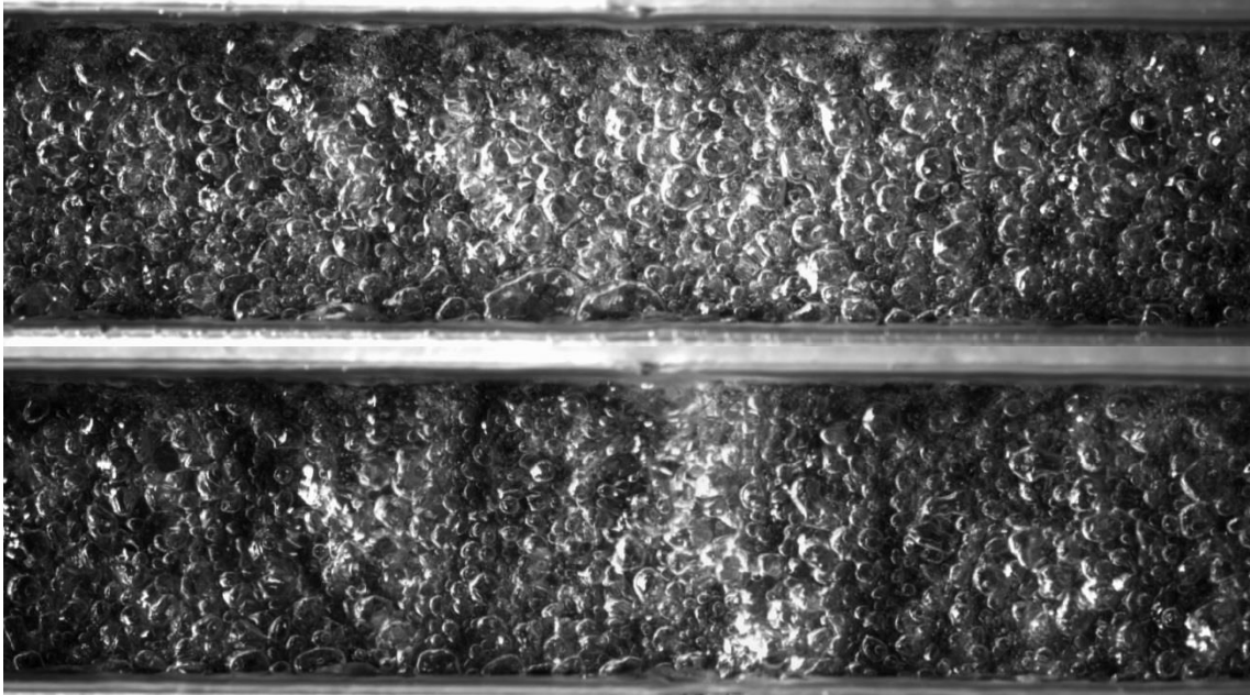
Fig. 5.9: Singoli frame estratti da riprese a q=50 \text{ kW m}^{-2} , G=100 \text{ kg m}^{-2} \text{ s}^{-1} e, rispettivamente, x=0,13 non attivata e x=0,15 attivata con variazione 0,13
