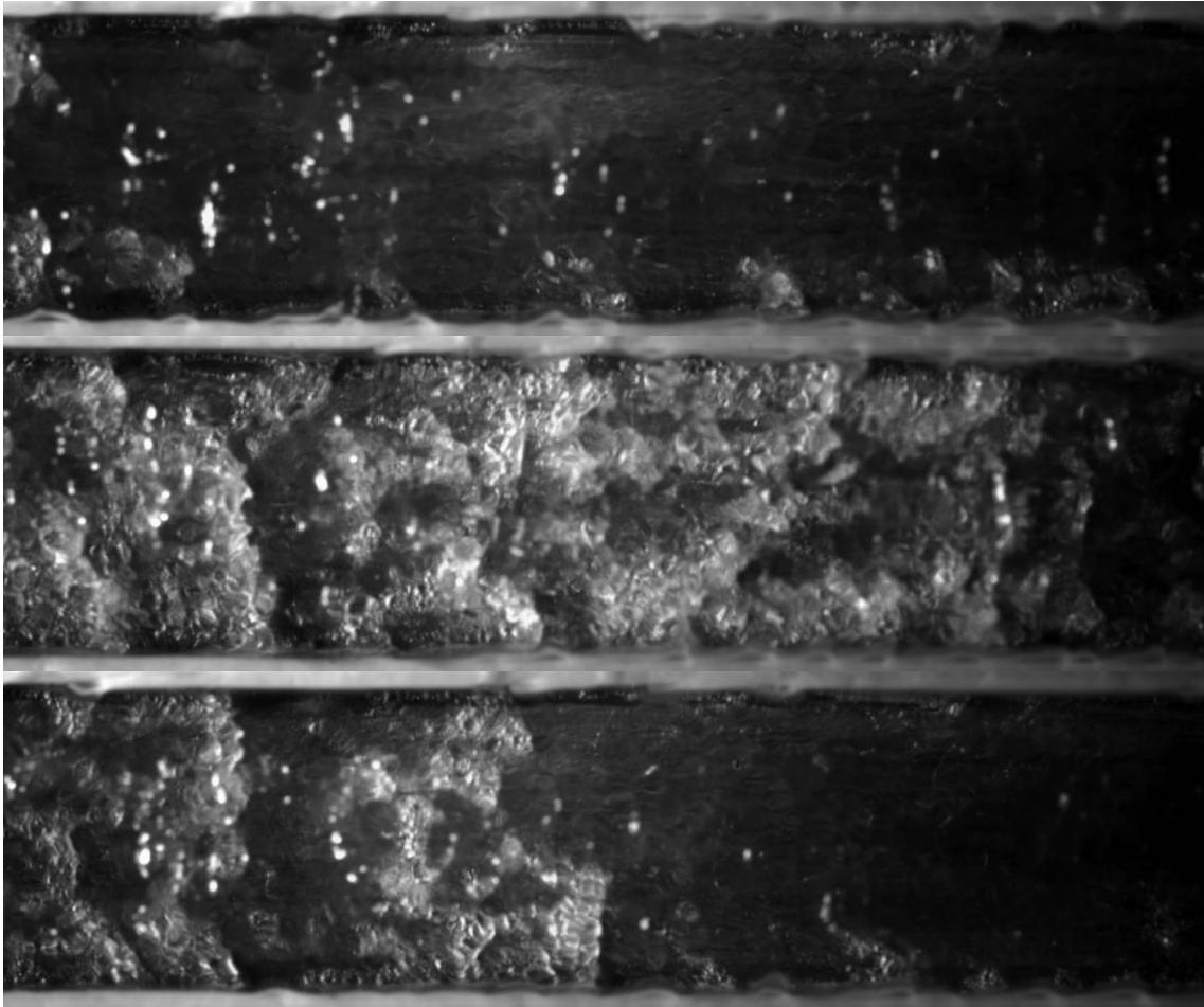
Fig. 5.5: Fenomeno del “dewetting-rewetting” in singoli frame estratti da riprese a q=50 \text{ kW m}^{-2} , G=100 \text{ kg m}^{-2} \text{ s}^{-1} , x=0,81 e variazione 0,13
