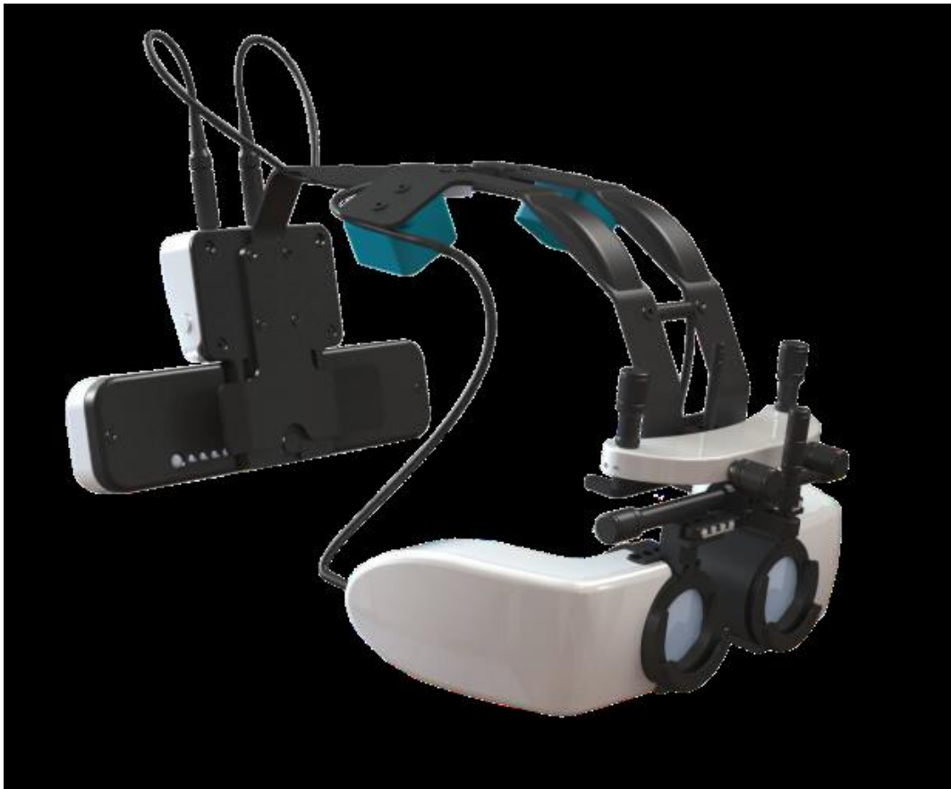
Figura 2.1 Unità indossabile del dispositivo VisionFit.
