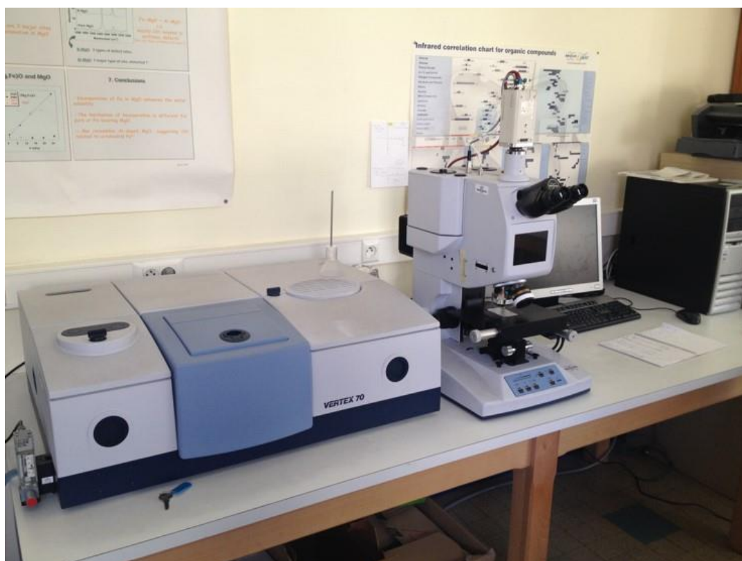
Figura 2. Strumento utilizzato per acquisire gli spettri infrarosso delle inclusioni: spettrometro Vertex70 Bruker accoppiato con un microscopio Hyperion equipaggiato con un obiettivo \times 15 .
