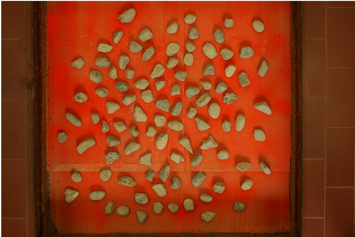
Figura 4.6. Trattenuto al setaccio \frac{3}{4} in, i cui grani sono stati volutamente disposti in modo da non entrare a contatto tra loro.
