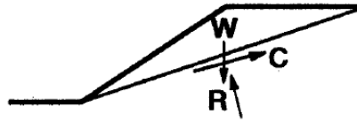
Figura 1.13. Schematizzazione di un versante e delle forze agenti che ne garantiscono la stabilità o instabilità.
