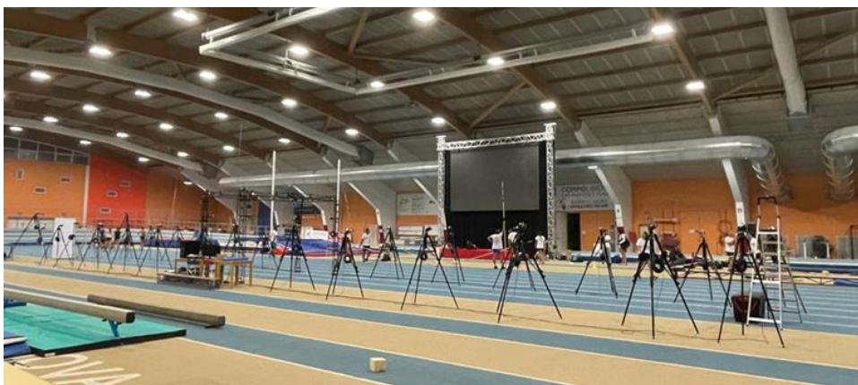
Figura 9 – Sistema di motion capture per le prova pilota del 5 ottobre all'interno del Palaindoor di Padova
