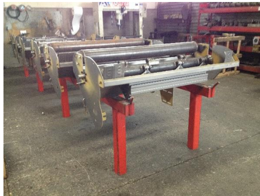
Figura 8.1 Supporto metallico isola di assemblaggio
