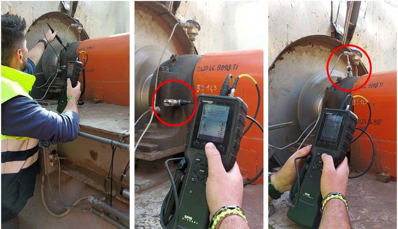
Figura 6.18 – Posizionamento del sensore per i rilievi vibrometrici al quarto punto “04 ventilatore lato opp accop”. Nella prima immagine a sinistra l’analista utilizza il trasduttore a impulsi d’urto con sonda per assicurarsi che le condizioni di salute del cuscinetto siano buone. La seconda e la terza foto mostrano il posizionamento del trasduttore in orizzontale (H) ed in verticale (V).
