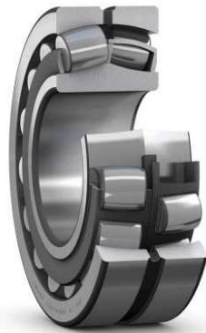
Figura 6.31 – Cuscinetto orientabile a rulli 22232 CC/C3W33 (SKF) (14) .
