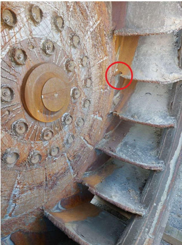
Figura 5.26 – Dettagli fotografici del grado di usura delle pale della girante.
