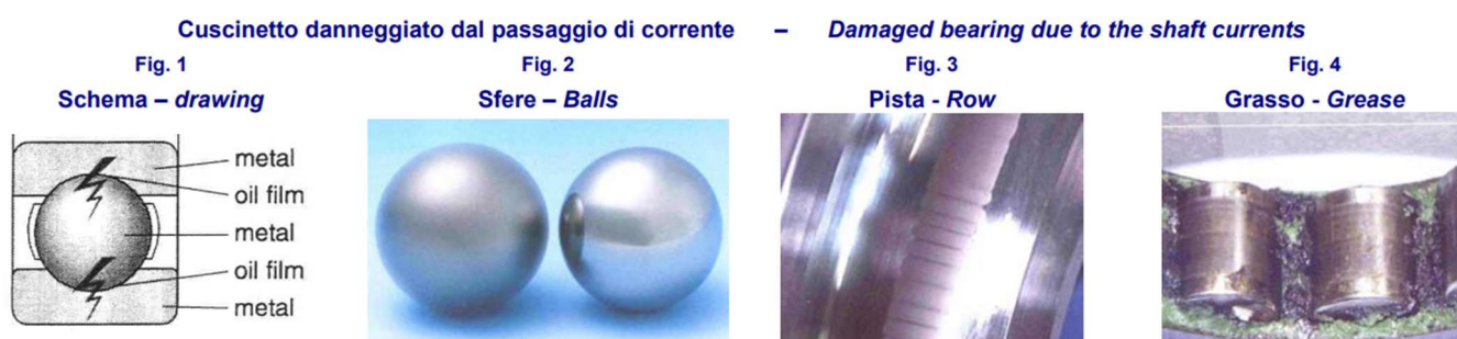
Figura 5.18 – Immagini che mostrano i danneggiamenti causati dal passaggio di corrente elettrica attraverso i cuscinetti [12]
