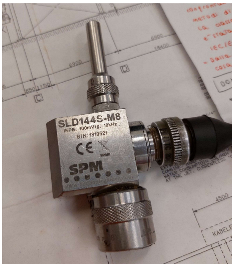
Figura 6.9 – Fotografia del trasduttore utilizzato, modello SLD144S-M8 di SPM Instruments AB .
