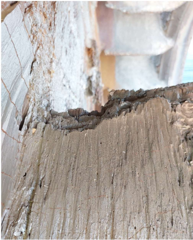
Figura 5.25 – Fotografie della girante usurata: si osservi, a sinistra, il grado di usura di una delle pale; a destra, quello di un bullone che appare molto levigato a causa di polvere, sabbia e altri detriti.
