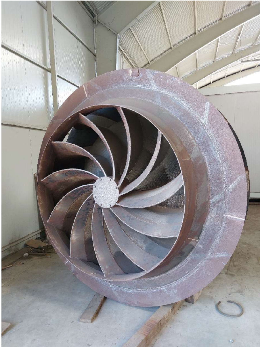
Figura 5.27 – Fotografia della girante che si prevede di sostituire a quella oggetto dello studio.
