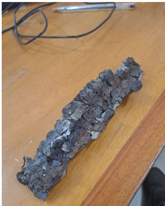
Figura 6.40 – Fotografia di un frammento metallico analogo a quello distaccatosi.
