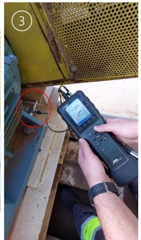
Figura 6.16 – Le fotografie (1) e (2) rappresentano rispettivamente la misurazione in direzione orizzontale al punto “02 motore lato accop” e l’ispezione tramite sonda del cuscinetto del motore. L’immagine (3) mostra il posizionamento del trasduttore nella direzione assiale.
