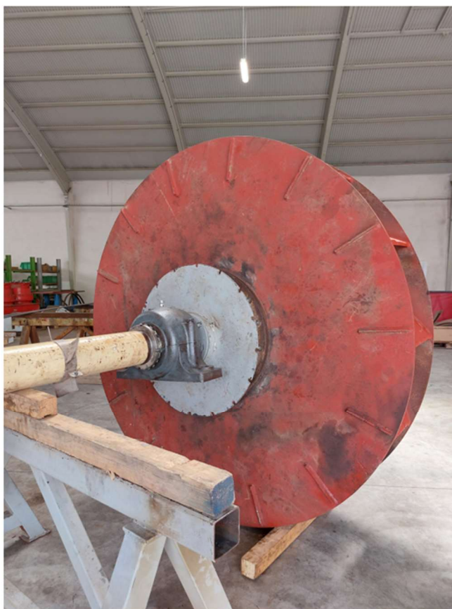
Figura 5.24 – Fotografie della girante riportata e verniciata.
