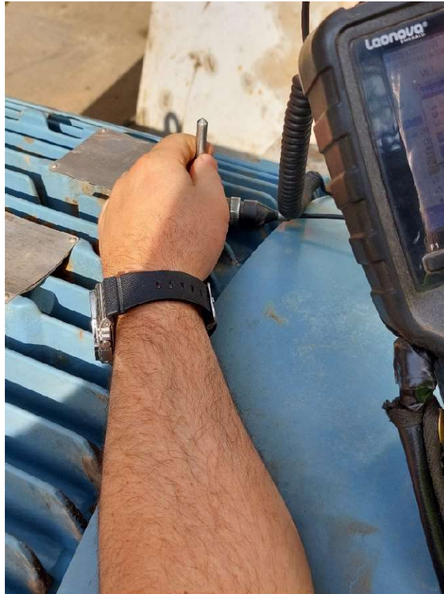
Figura 6.15 – Misurazione in direzione verticale (V) del punto “01 mot lato opp accop”
