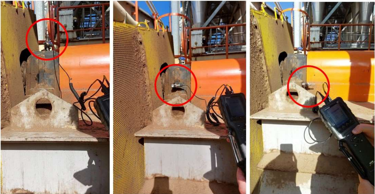
Figura 6.17 – Posizionamento dell’accelerometro per la misurazione delle vibrazioni del terzo punto “03 ventilatore lato accop” nelle tre direzioni. Da sinistra: verticale (V), orizzontale (H), assiale (A).
