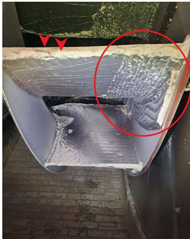
Figura 5.21 – Foto del riporto eseguito con filo Endotec DO48 Castolin. I due indicatori in alto a sinistra mostrano i due strati esistenti: uno costituisce la base ferrosa della pala della girante mentre quello sotto mostra il riporto. Il cerchio a destra mette in evidenza il filo di saldatura: sulla destra è visibile il disco della girante ricoperto dal filo.
