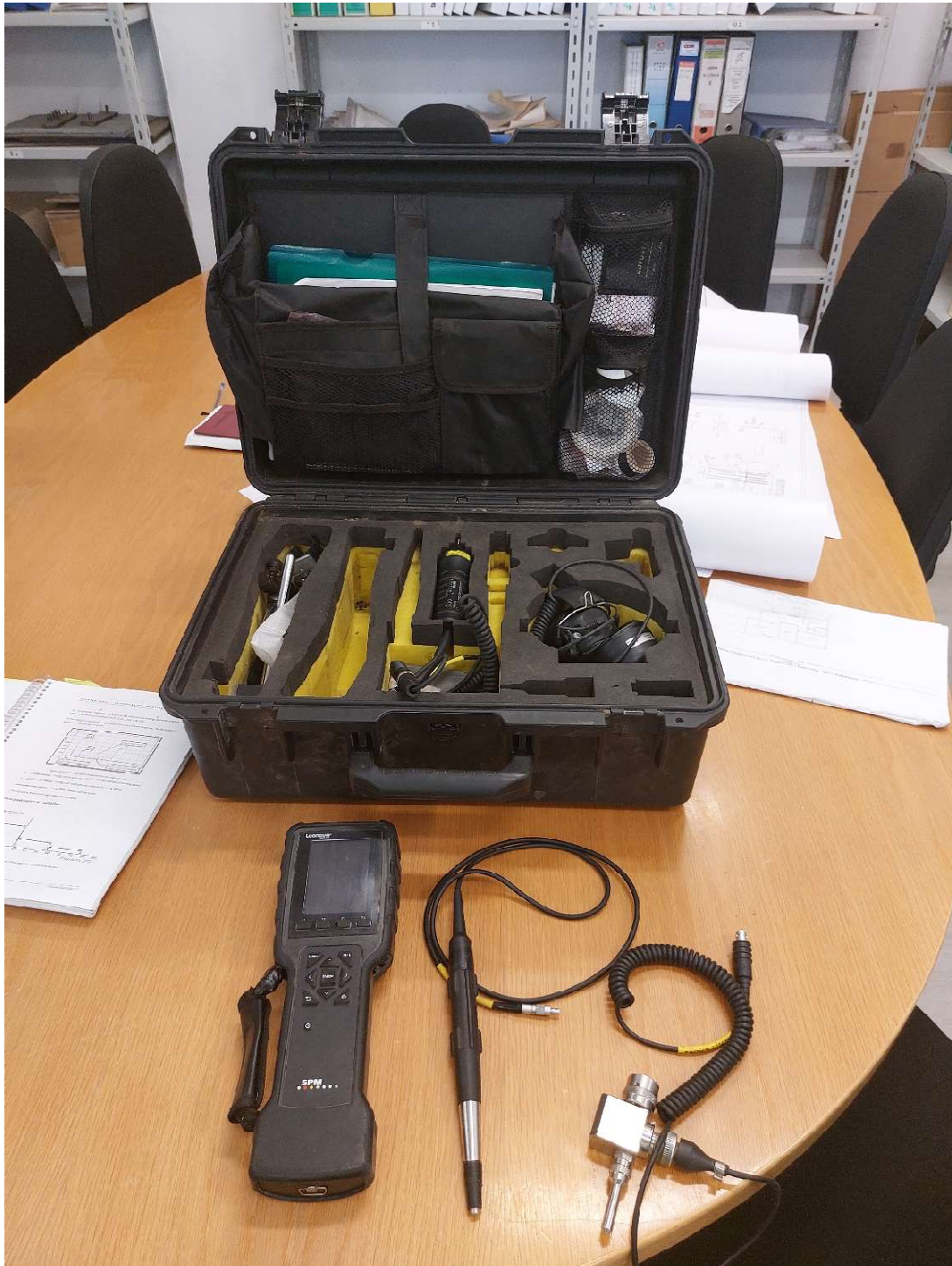
Figura 6.5 – Fotografia del Leonova Emerald e dell'equipaggiamento in dotazione: valigetta per il trasporto, cuffie, sonda tachimetrica e di temperatura, trasduttori di vibrazione e trasduttori SPM..
