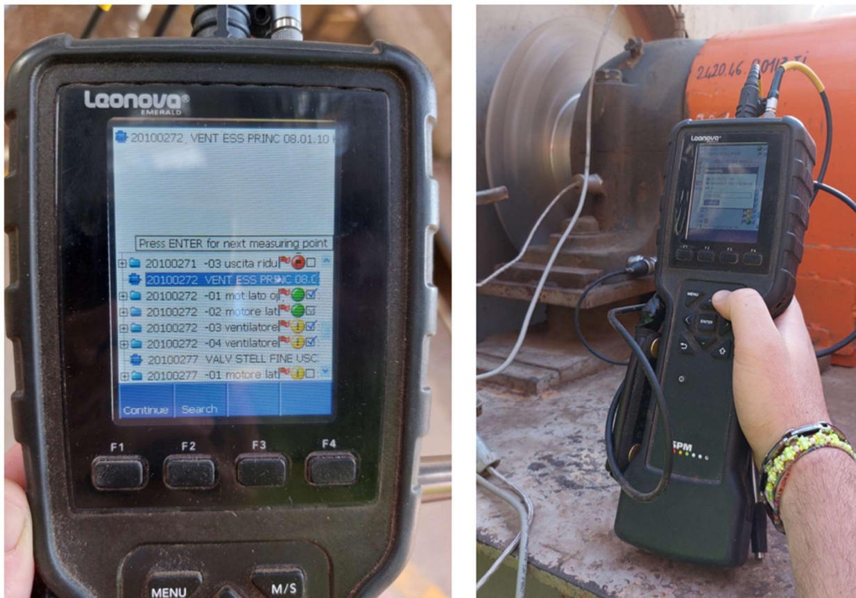
Figura 6.6 – Schermata di selezione della macchina che si intende misurare del Leonova Emerald. Il ventilatore del caso studio è denominato “VENT ESS PRINC”. L’immagine a destra è rappresentativa della portatilità dello strumento durante un’operazione di misurazione delle vibrazioni.
