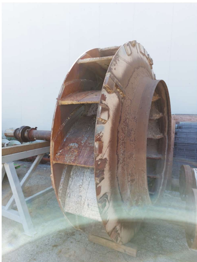
Figura 5.23 – Fotografie della girante usurata.
