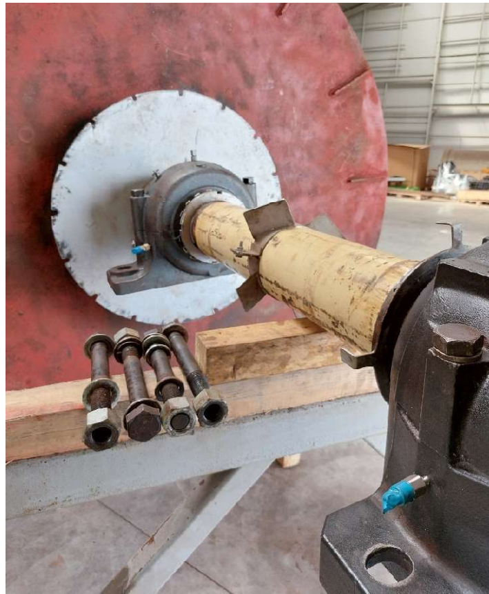
Figura 6.12b – Punto di connessione per sensori di vibrazione fissi sull'albero del ventilatore.
