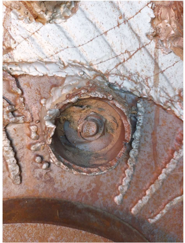
Figura 5.25 – Fotografie della girante usurata: si osservi, a sinistra, il grado di usura di una delle pale; a destra, quello di un bullone che appare molto levigato a causa di polvere, sabbia e altri detriti.
