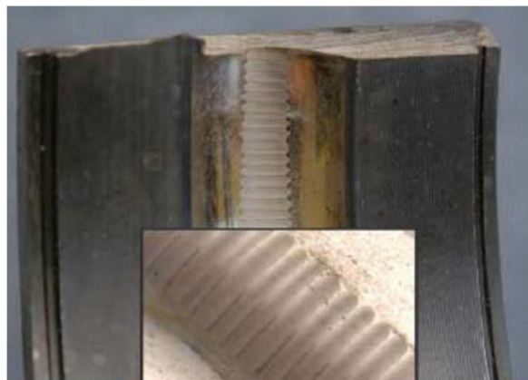
Figura 6.41 – Ondulazioni sulla pista del cuscinetto dovute al passaggio di corrente; Caso di fluting [24].
