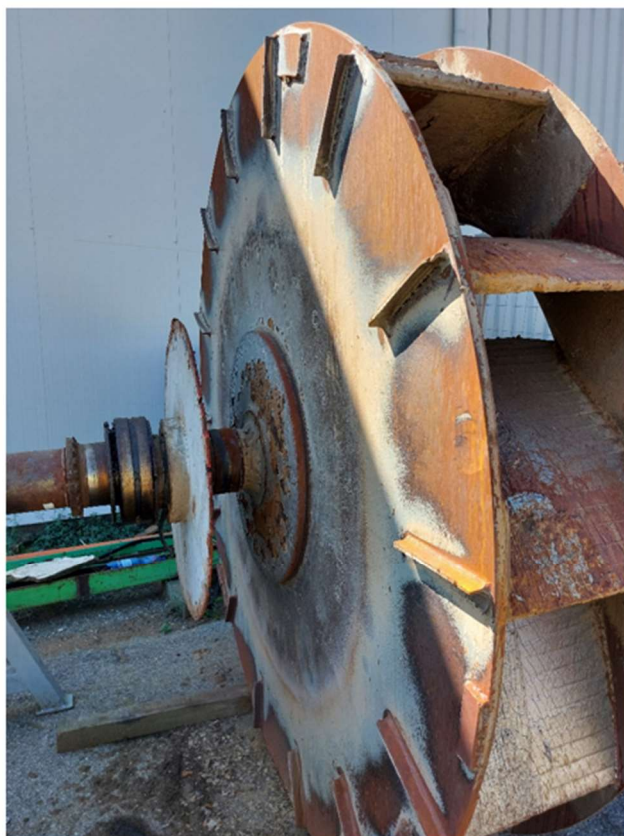
Figura 5.23 – Fotografie della girante usurata.
