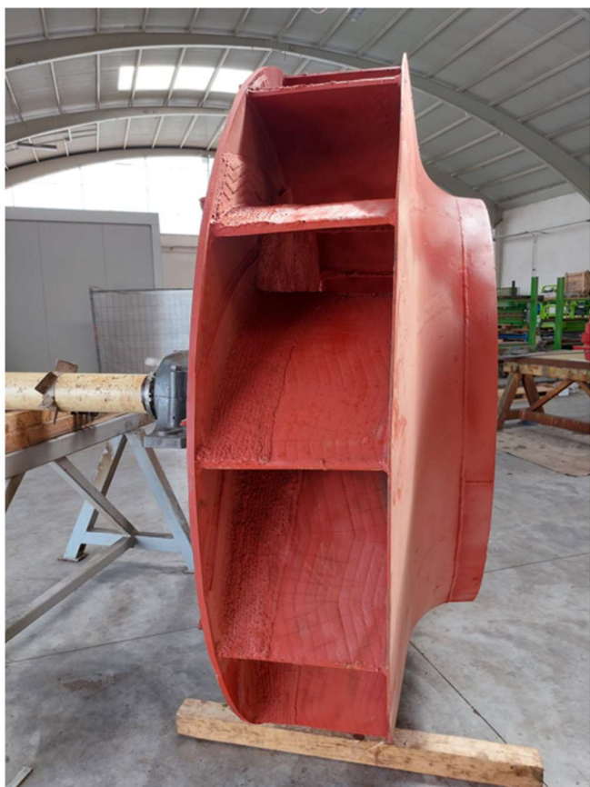
Figura 5.24 – Fotografie della girante riportata e verniciata.
