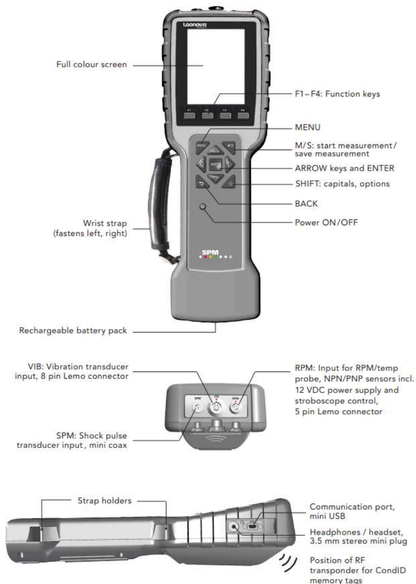
Figura 6.4 – Panoramica dello strumento Leonova Emerald [18] .
