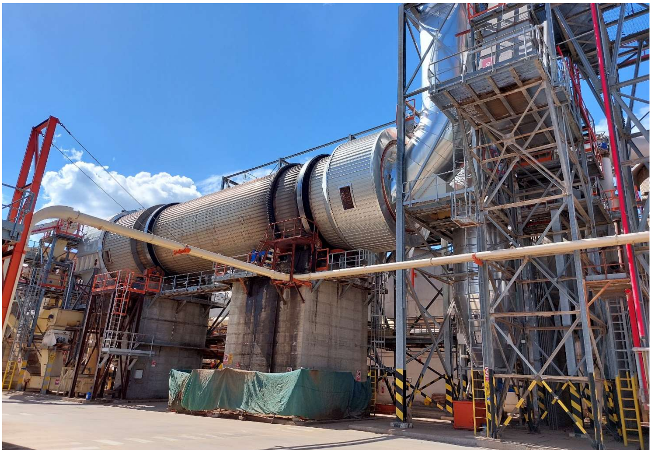
Figura 5.6 – Foto dell'essiccatoio a tamburo rotante, vista ovest.
