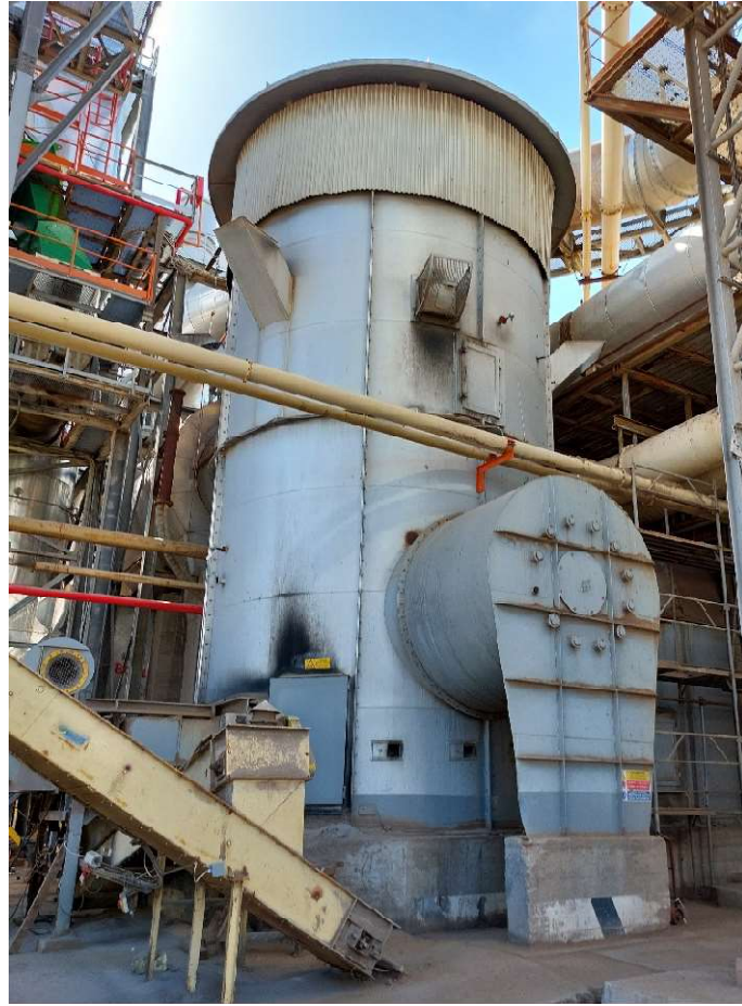
Figura 5.7 – Foto della camera di combustione. All'interno della camera di combustione viene bruciato il polverino. Tale elemento, in associazione al bruciatore, permette di raggiungere le elevate temperature richieste all'inizio del processo di essiccazione.
