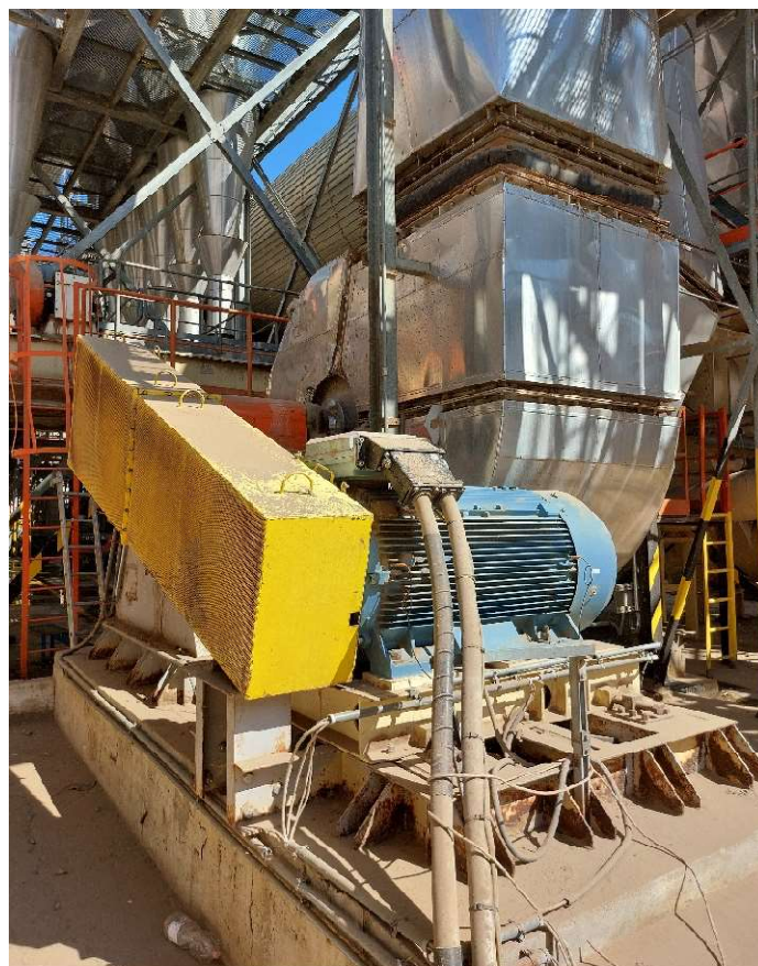
Figura 5.11 – Foto del ventilatore dell'essiccatoio. Da questo punto di vista è possibile osservare anche il motore del ventilatore stesso.
