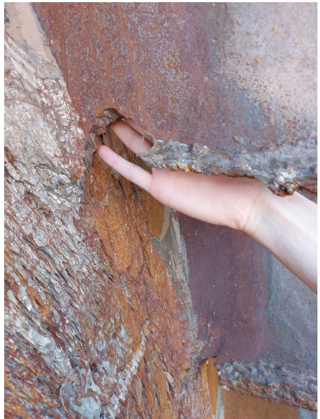
Figura 5.26 – Dettagli fotografici del grado di usura delle pale della girante.
