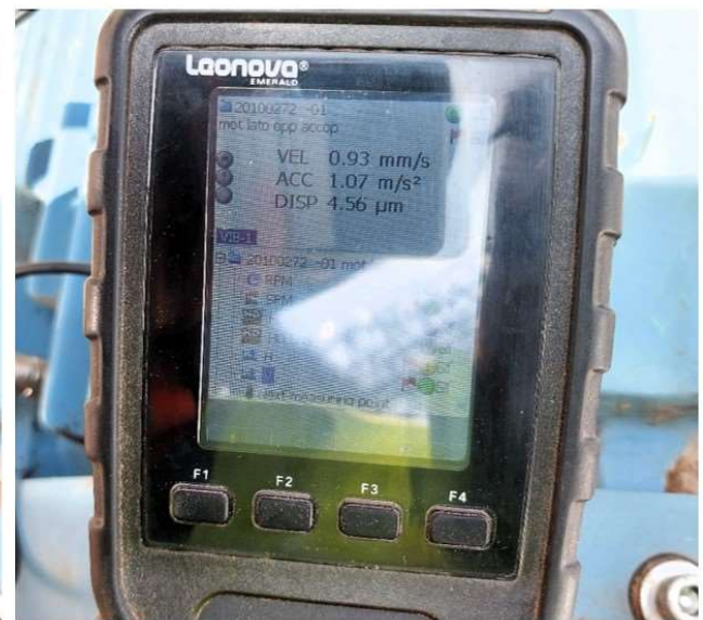
Figura 6.14 – Misurazione in direzione orizzontale (H) in pozione “01 mot lato opp accopp”, lato del motore opposto all’accoppiamento. In alto è possibile vedere l’analista durante le rilevazioni; in basso viene mostrato il display del collettore nelle fasi di “measuring” (a sinistra) e a misurazione completata (destra).
