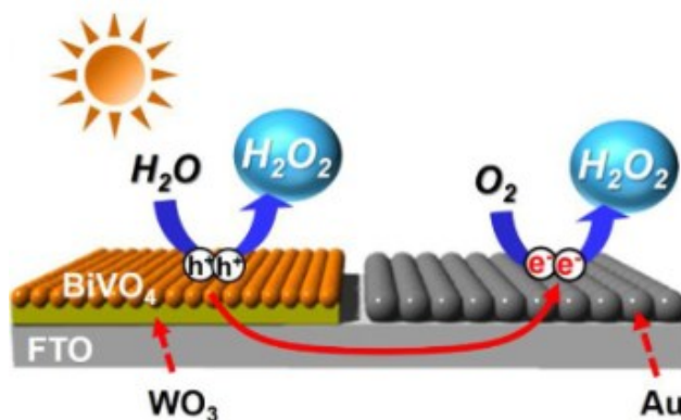
Figura 10. Schema di reazione per la produzione di H_2O_2 con fotoanodo in WO_3/BiVO_4 e catodo di oro [3].
