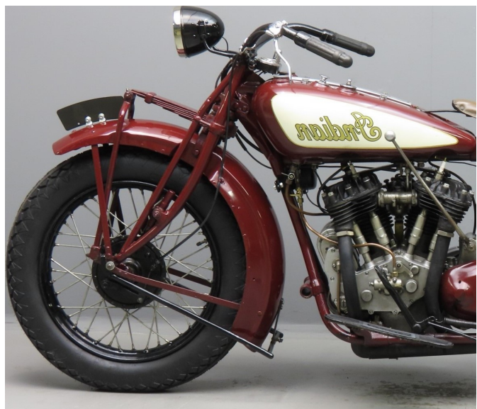
Figura 6: Sospensione Trailing Link di una Indian 1200 del 1930
