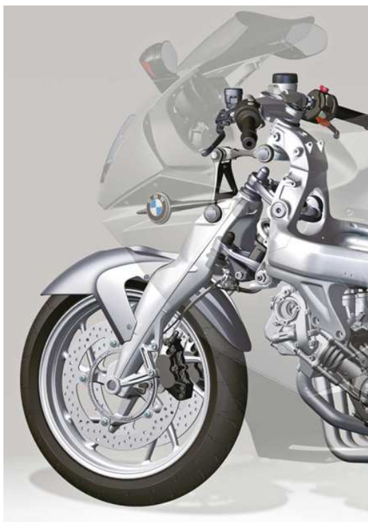
Figura 11: Sospensione Duolever di una BMW K1200
