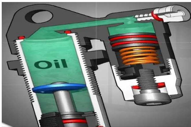
Figura 30: Vaso di espansione esterno nell'ammortizzatore telescopico con molla esterna della sospensione Telelever
