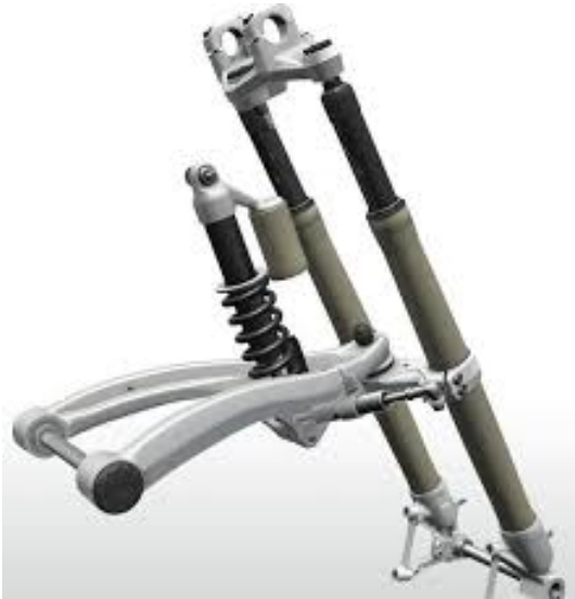
Figura 23: Disegno 3D sospensioni Telelever di una BMW R1200GS
