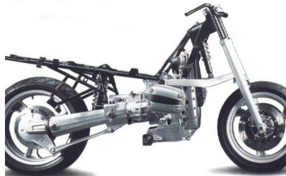
(b) Sospensione Telelever di una BMW R1100RS del 93
