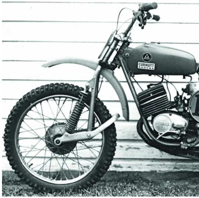
Figura 8: Sospensione Leading Link della Curnutts su una Super Rat Hodaka
