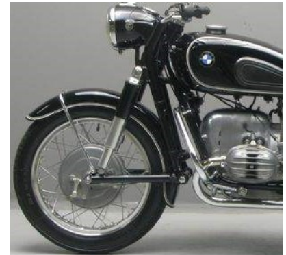
Figura 9: Sospensione Earles di una BMW R50 del 1955
