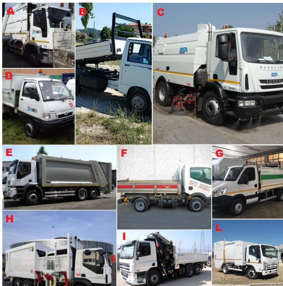
Figura 10 Mezzi utilizzati nella città di Padova: a) Autocompattatori carico posteriore Ton 6-18 b) Motocarri con cassone fisso c) Autospazzatrici aspiranti d) Motocarri con vasca ribaltabile e) Autocompattatore carico posteriore Ton 24-33 f) Autocarri furgonati g) Autocompattatori Ton 3,5 h) Autocompattatori side-loader i) Autocarri con gru l) Lavacassonetti
