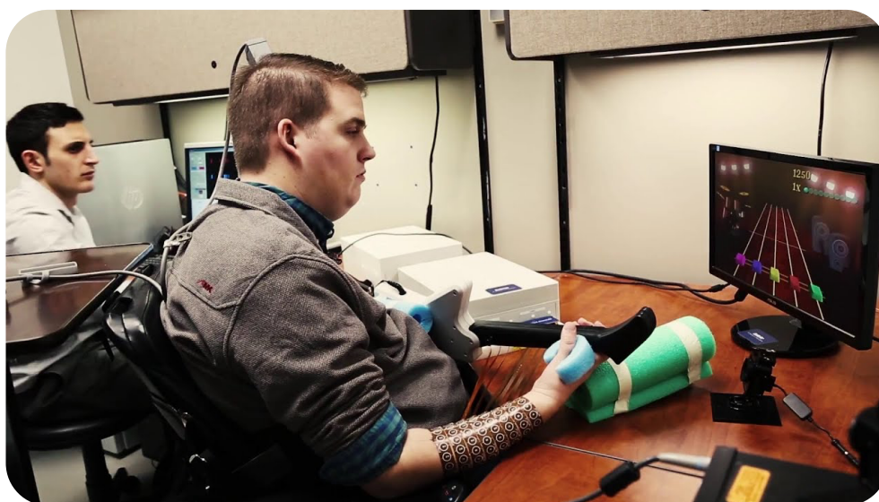
Figura 13: Ian Burkhart, paziente tetraplegico, gioca a Guitar Hero. La sua mano è controllata da degli elettrodi esterni comandati a loro volta dal cervello di Ian tramite l'utilizzo di uno Utah Array.
