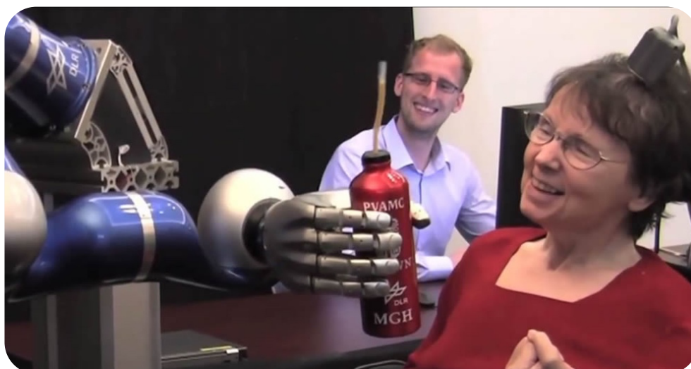
Figura 12: La donna tetraplegica in foto porta a sé una bottiglia muovendo un braccio robotico con il suo solo pensiero grazie all'impianto di due Utah Arrays.
