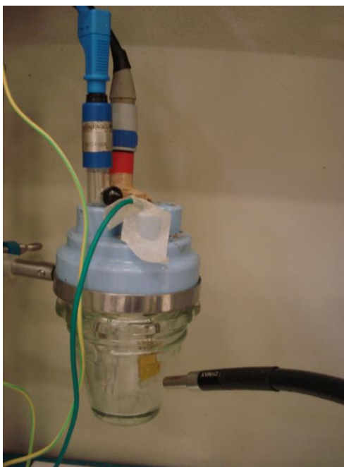
Figura 2.7. Fibra ottica usata per irradiare l'elettrodo lavorante con un fascio UV durante le caratterizzazioni elettrochimiche in PBS 1X.
