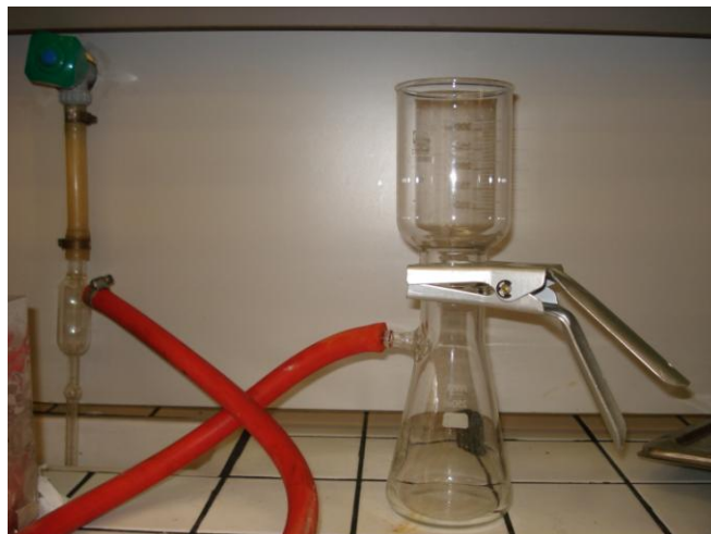
Figura 2.4. Sistema di filtrazione per i nanotubi ossidati. La membrana che trattiene i nanotubi è in Teflon da 0.22\ \mu\text{m} . La filtrazione avviene in depressione per favorire l'essiccazione dei nanotubi. Si aggiunge acqua fino al raggiungimento di un pH neutro.
