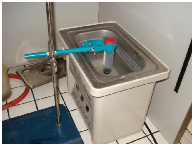
Figura 2.3. Bagno ad ultrasuoni utilizzato (CP 104, Ceia, Italia). La potenza viene mantenuta costante a 500 W.
