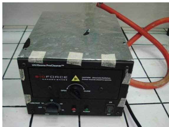
Figura 2.2. Apparecchiatura per plasma UV-ozono utilizzata nel trattamento idrossilativo (durata: 15 minuti) della superficie di FTO.
