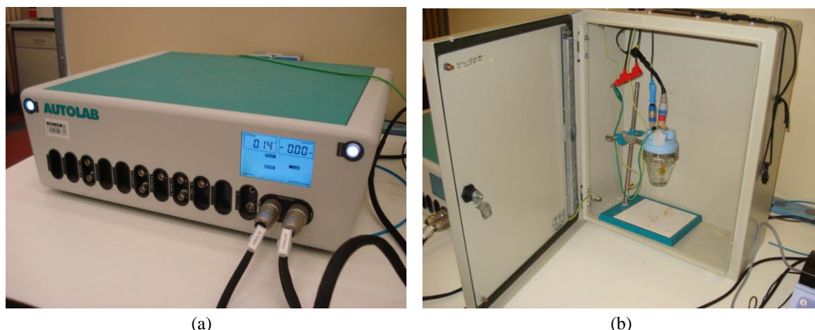
Figura 2.6. (a) Potenziostato-galvanostato; (b) cella elettrochimica a tre elettrodi posta all'interno di una gabbia di Faraday.
