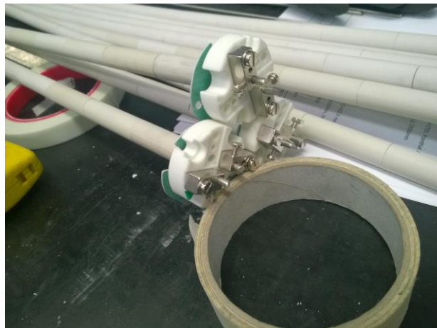
Fig. 23 A sinistra si sta provvedendo ad infilare l'isolante, a destra la termocoppia è stata completata anche con la basetta ceramica (per gentile concessione di E+H).
