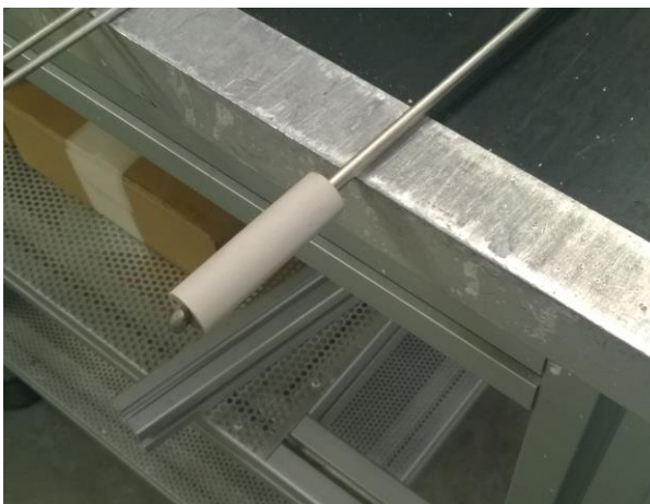
Fig. 23 A sinistra si sta provvedendo ad infilare l'isolante, a destra la termocoppia è stata completata anche con la basetta ceramica (per gentile concessione di E+H).
