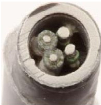
Fig. 25 La foto mostra la punta del sensore dopo che è stata tagliato il giunto caldo, il materiale verde che si vede è l'ossido di cromo, dovuto al green rot .
