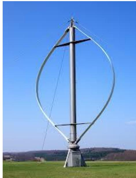
**Figura 2.6.** Esempi di macchina di Savonius e di Darreius
