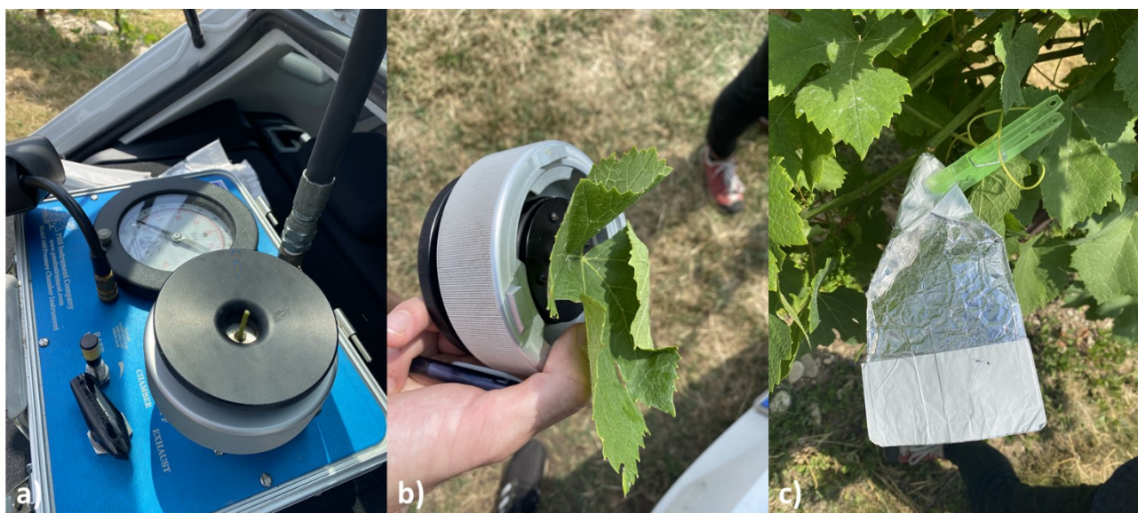
Fig. 4: a) Camera a pressione di Scholander, b) Preparazione campione, c) Involucro.
