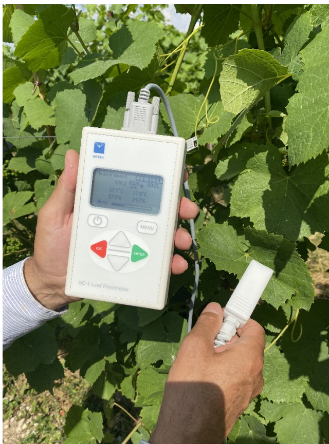
Fig. 3: Porometro e misura in campo della conduttanza stomatica.
