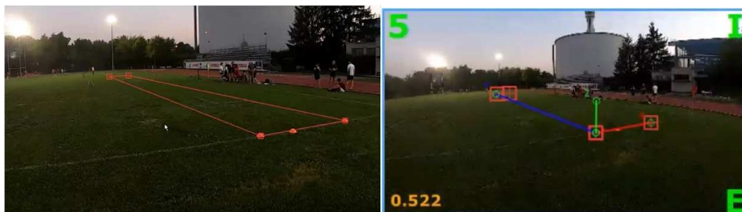
Figura 15_Esempio di calibrazione su Track On Field
