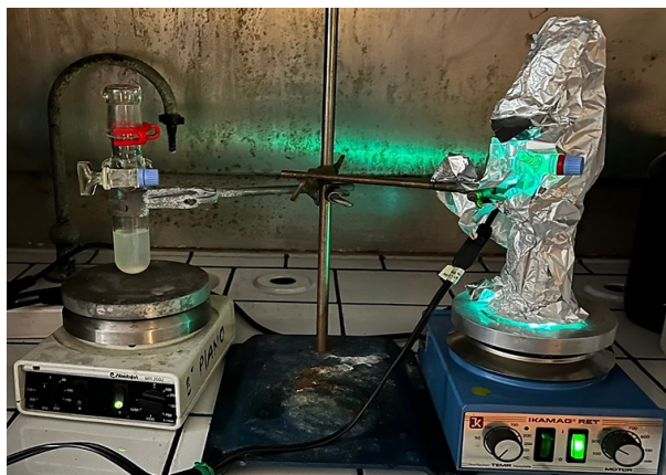
Figura 34 - Setup sperimentale per i test ex-situ . A sinistra il tubo di Schlenk senza irraggiamento UV, a destra il tubo di Schlenk in cui viene svolto l'esperimento in presenza di luce UV
