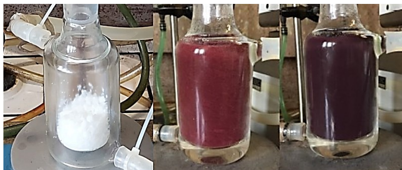
Figura 19 - Fasi della solfonazione: resina rigonfiata in DCE (a sinistra), resina dopo l'aggiunta di acido solforico concentrato (al centro), resina al termine della funzionalizzazione (a destra)
