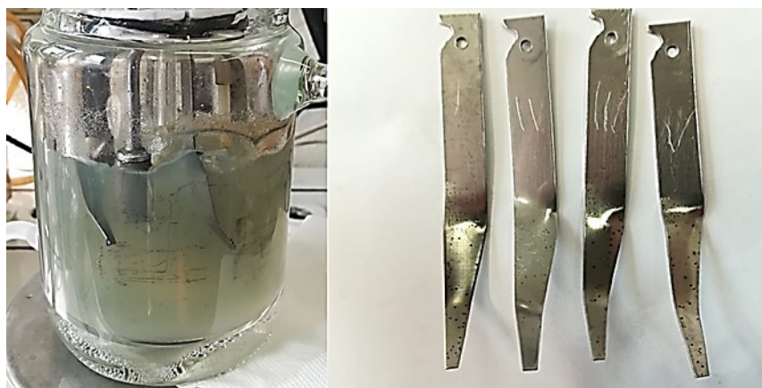
Figura 41 - A sinistra, il reattore al termine del test con bromuri. A destra, evidenti segni di corrosione sui baffle di acciaio
