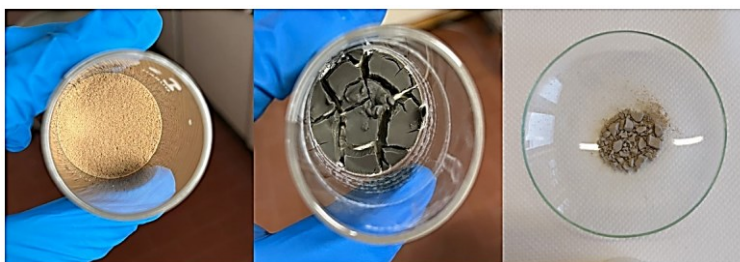
Figura 22 - 1% w/w di Pd/pDVB-SO 3 H prima della riduzione (a sinistra); 1% w/w di Pd/pDVB-SO 3 H bagnato dopo riduzione (al centro); 1% w/w di Pd/pDVB-SO 3 H dopo riduzione ed essiccamento (a destra)
