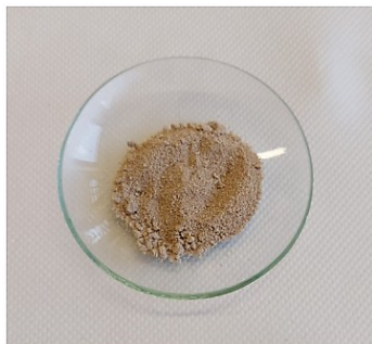
Figura 20 - pDVB-SO 3 H dopo lavaggio, asciugatura in stufa a 110°C per una notte e macinazione (granulometria compresa tra 180 nm e 400 nm)
