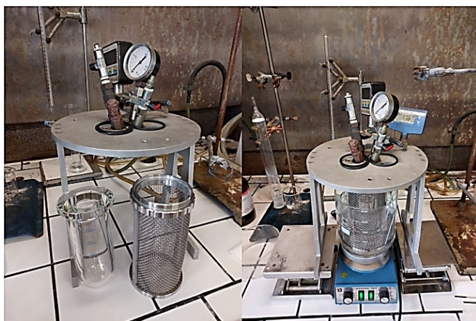
Figura 21 - A sinistra, l'autoclave di vetro utilizzata per la riduzione del Pd(II) sul supporto di pDVB-SO 3 H. A destra, l'autoclave durante la reazione
