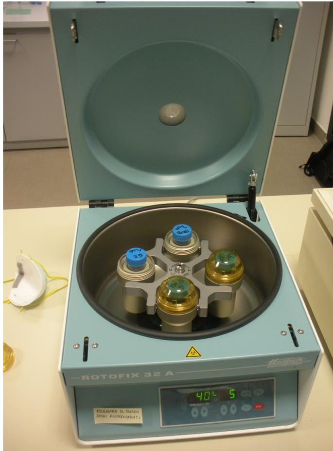
**Centrifuga da laboratorio:** utilizzata per forzare la sedimentazione del campione e permettere la separazione del liquido dal solido
