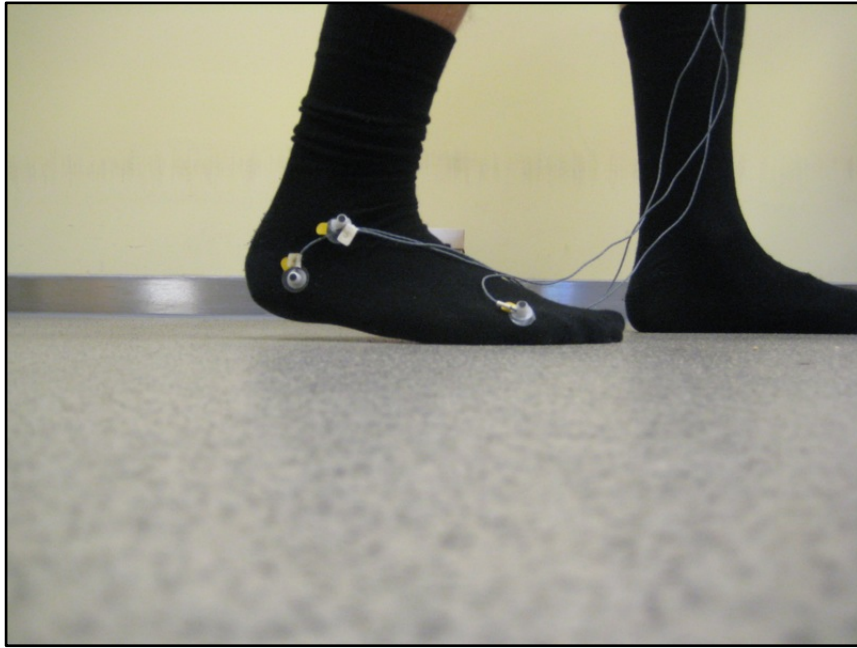
Fig. 2.14 Dettaglio dei tre markers posti sul piede: malleolo laterale (caviglia), tallone e quinto metatarso.
