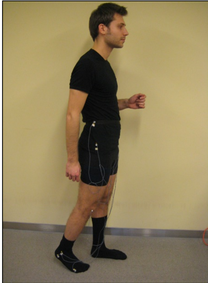
Fig. 2.12 Illustrazione dei sei markers posizionati sull'arto inferiore destro di un soggetto.
