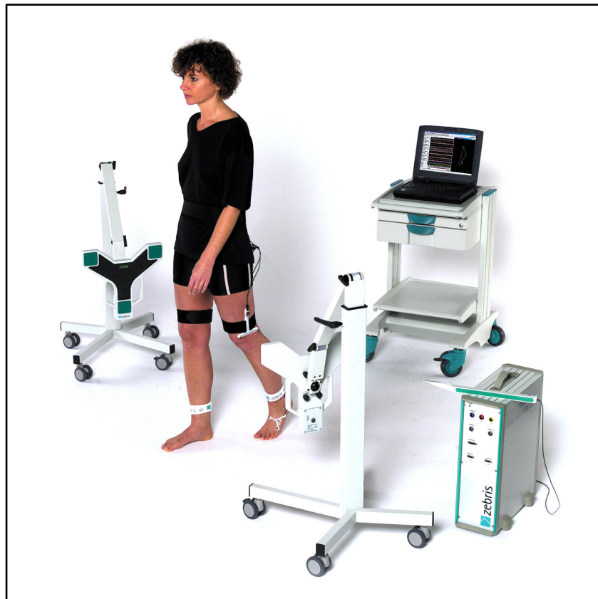
Fig. 2.8 Esempio di utilizzo del sistema di misura Zebris durante il cammino di un soggetto. Tutti i componenti del sistema descritti in precedenza sono illustrati in figura.
