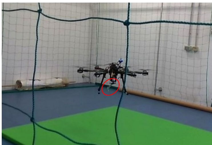
Figura 5. 3 Esacottero con braccetto (cerchiato in rosso) durante gli esperimenti
