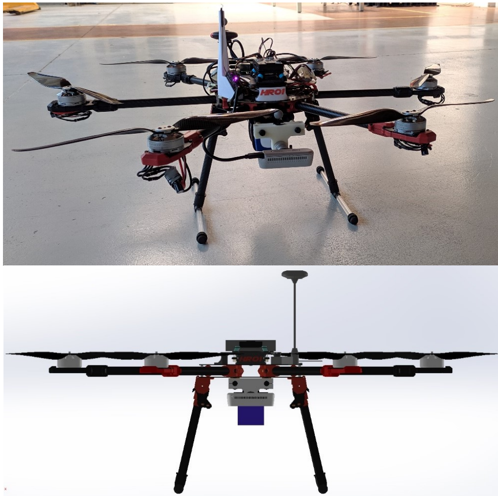
Figura 5. 1 Esacottero utilizzato per gli esperimenti: in alto foto del drone, in basso vista frontale da Solidworks (in blu si può distinguere la batteria al di sotto della quale verrà posizionato un braccetto per disturbare l'UAV)
