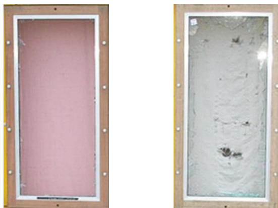
Fig. 2-16 Confronto tra il comportamento in risposta ad esplosione in un tessuto auxetico e uno convenzionale usato comunemente in ambito militare.
