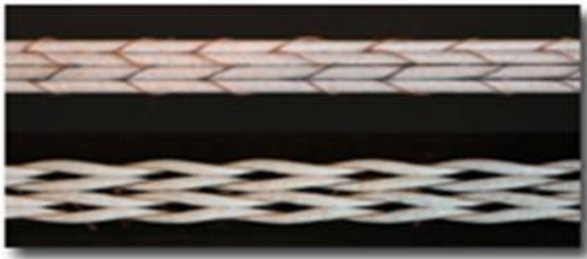
Fig. 2-10 Meccanismo deformativo tessuto auxetico.
