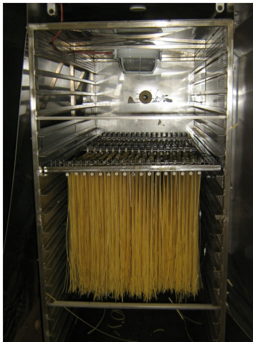
Figura 2.3 Tagliatelle su canne poste all'interno della cella statica
