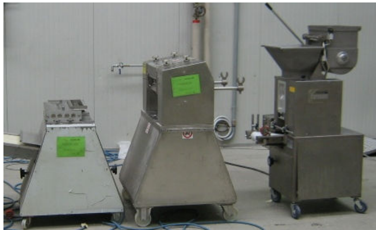
Figura 2.2 Impianto pilota per tagliatelle (a partire da destra: impastatrice, laminatoio, taglierina)
