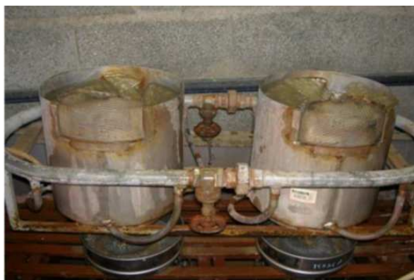
Figura 3.6. Impianto di lavaggio delle carote di terreno.
