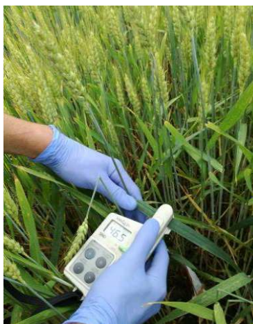
Figura 3.4. Pinzatura della foglia di frumento per la misurazione dello SPAD.
