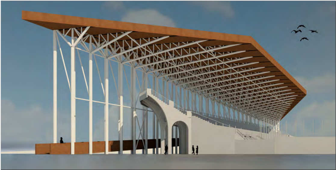
Figura 10.2.3: Soluzione strutturale 1 - Trave reticolare. Vista da Nord.
