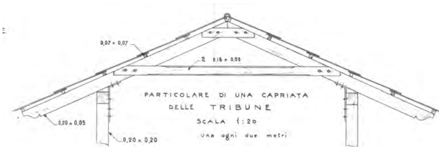
Figura 6.3.2: Dettaglio costruttivo della capriata in legno con copertura in eternit. Fonte: [7]
