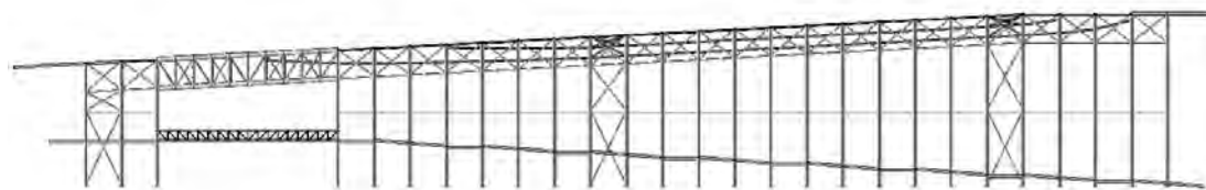
Figura 9.1.5: Schema dei controventi nel piano verticale longitudinale.
