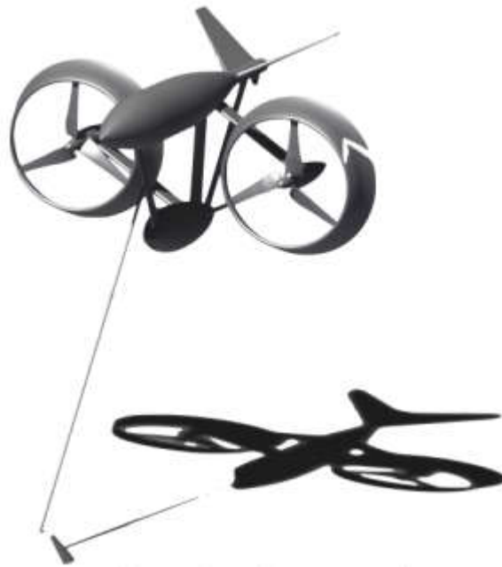
Figura 15: Rappresentazione CAD dell'ancoraggio a cavo singolo di GEMSTAR (da SEAPOWER)
