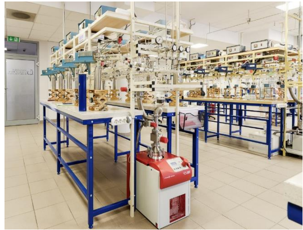
Fig. 32. Sistema a vuoto per la grafitizzazione di campioni nel laboratorio al radiocarbonio di Poznań e postazioni di lavoro durante la fase di preparazione del campione da datare all'interno del laboratorio. . https://radiocarbon.pl/preparatyka-grafityzacja/ .
