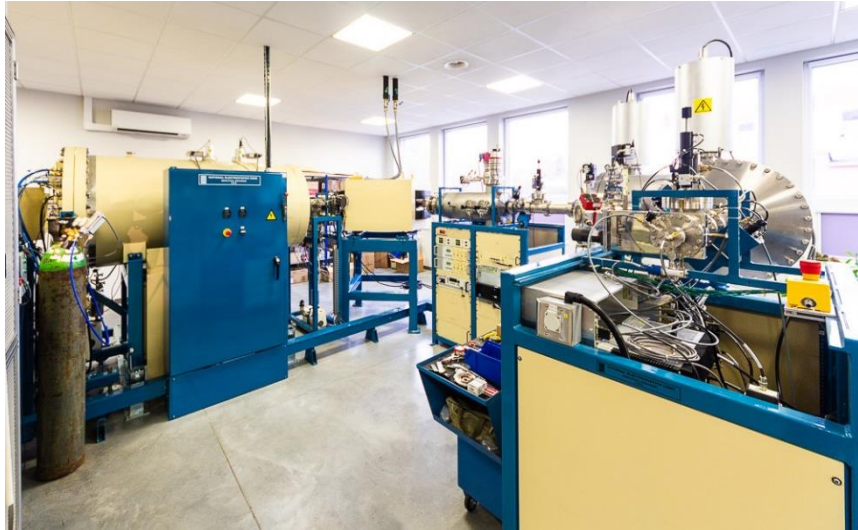
Fig. 33. Rappresentazione del laboratorio AMS, dotato di due spettrometri di massa con acceleratore tipo 1.5 SDH-Pelletron Modello "Compact Carbon AMS" prodotti dalla National Electrostatics Corporation, Middleton (USA). https://radiocarbon.pl/spektrometr-ams-ogolne-informacje/
