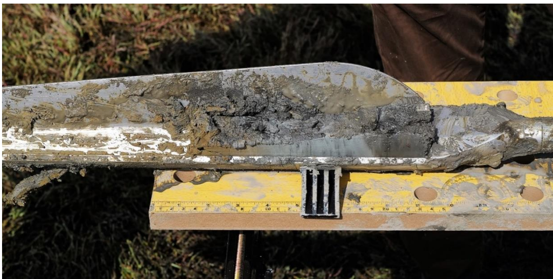
Fig. 34. Immagini fotografiche di tre dei quattro spezzoni della carota NR. Le foto sono state scattate ai singoli spezzoni ancora contenuti nella sonda russa, qui vista aperta, utilizzata come carotiere manuale per l'estrazione, durante la prima osservazione e descrizione qualitativa del sedimento. Foto di Venturoli, 2021.
