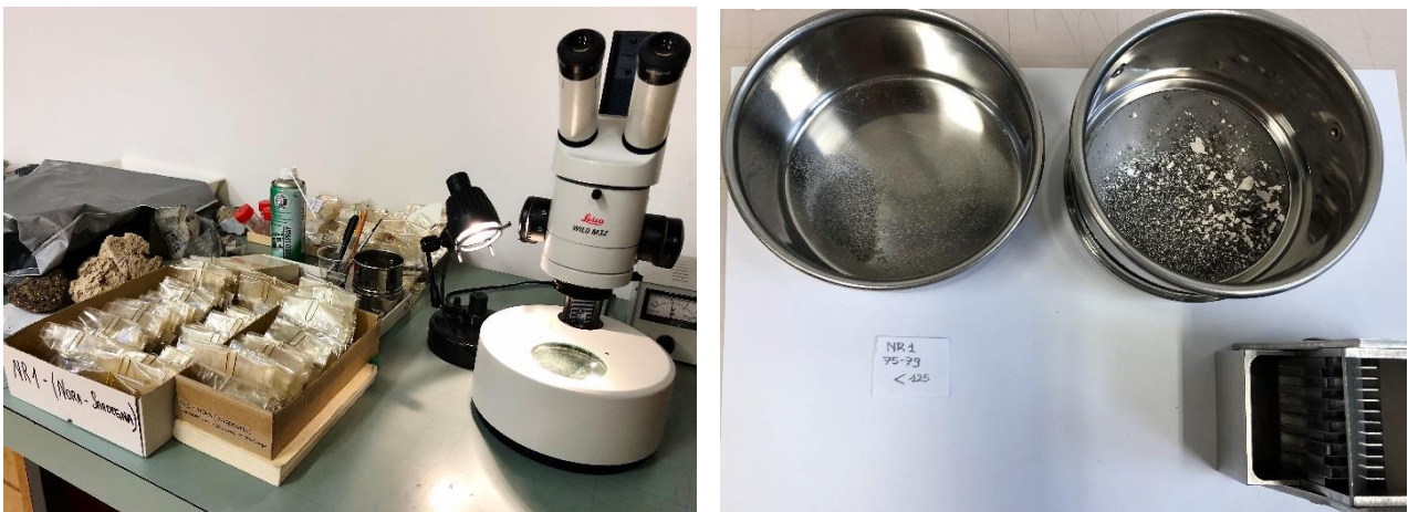
Fig.28. Strumenti utilizzati nel Laboratorio di Micropaleontologia dell'Università di Bologna: microscopio binoculare stereoscopico, dotato di zoom con obiettivo da 0,5X; sacchetti di plastica e vetrini; pennellino e acqua distillata, setaccio con maglie in acciaio inox da 125 \mu\text{m} e microsplitter. Foto di Venturoli, 2021.
