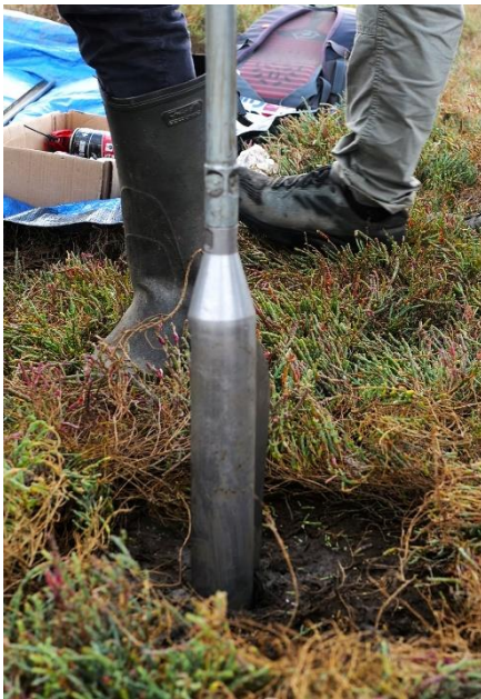
Fig.26. A destra: il carotiere russo usato in questa campagna di carotaggio. A sinistra: la porzione di terreno estratta tramite uso della sonda russa viene successivamente posizionata in un tubo di plastica con indicazione del sondaggio e delle dimensioni, dal punto di vista della profondità, dello spezzone. Foto di Venturoli, 2021.
