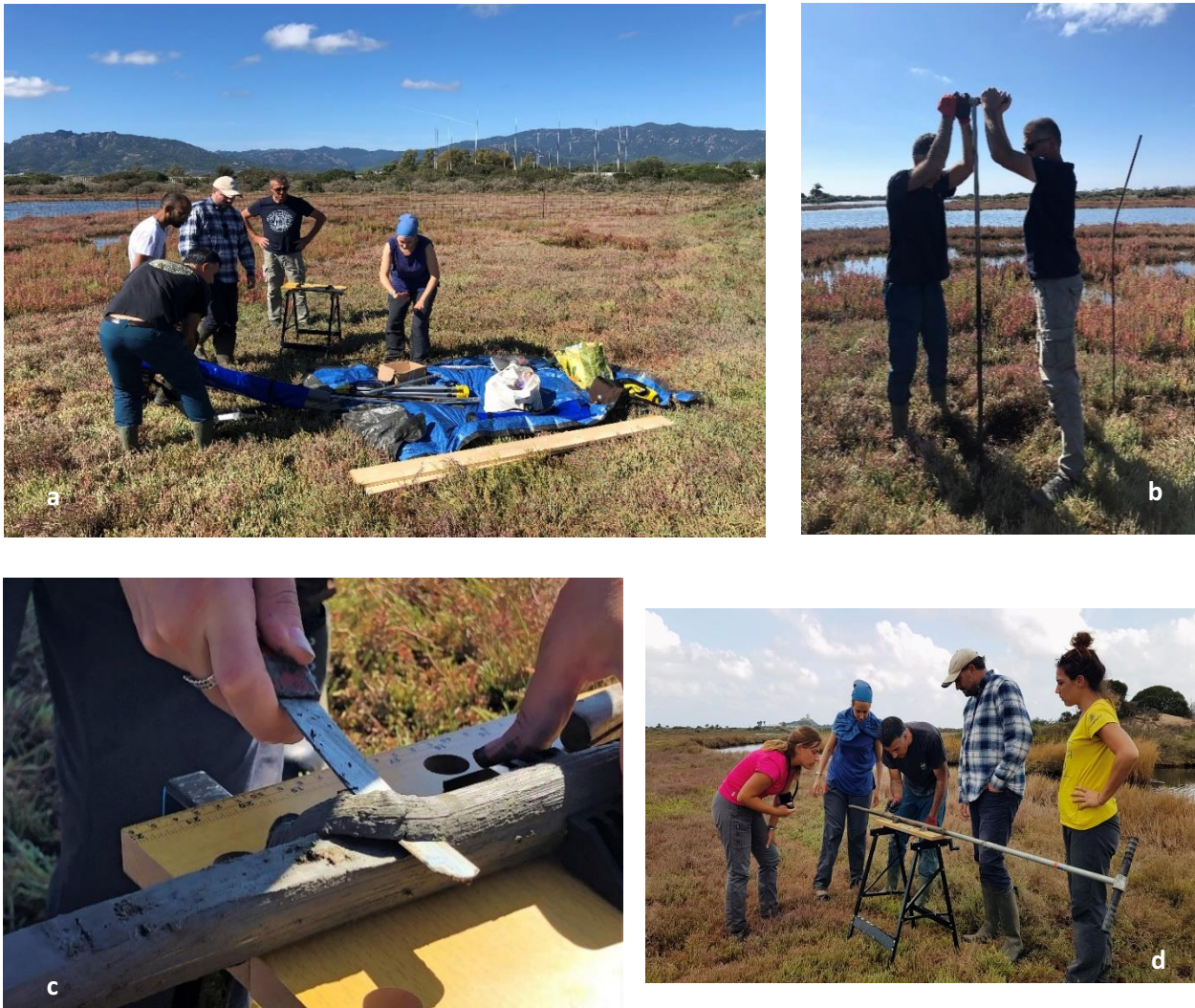
Fig.25. Alcune immagini fotografiche scattate durante le operazioni di carotaggio: a) preparazione dei materiali e degli strumenti; b) valutazione del punto in cui effettuare il primo sondaggio con carotiere a calibro aperto; c) preliminare valutazione del sedimento; d) osservazione e fotografia di ogni spezzone. Foto di Carraro e Venturoli, 2021.
