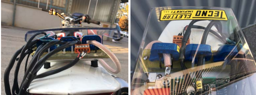
Figura 6.16: Scheda con i trasduttori di corrente
