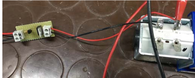
Figura 6.12: Scheda di pilotaggio teleruttore
