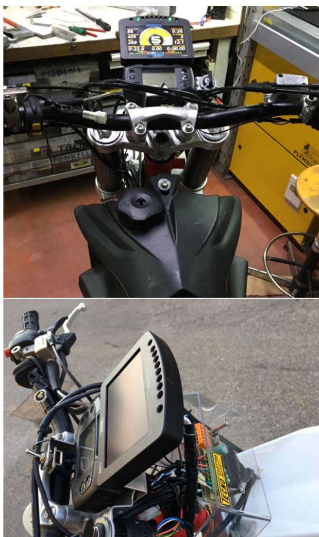
Figura 6.2: Display e relativa scheda di filtraggio dei segnali per l'acquisizione dati
