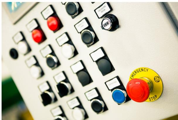
Figura 3.3 Nel pannello di controllo di una macchina, risalta il fungo di arresto rapido, che, secondo la norma EN 60204: 2018 relativa all'equipaggiamento elettrico delle macchine, deve essere rosso su sfondo giallo per essere ben individuabile
