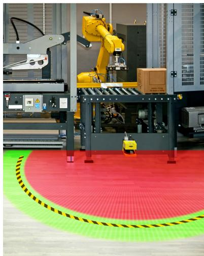
Figura 6.1 Laser scanner impiegato come sistema di sicurezza
