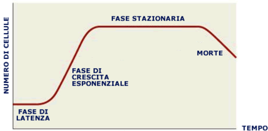
Figura 1.6. Rappresentazione schematica della curva di crescita delle microalghe in un reattore batch.
