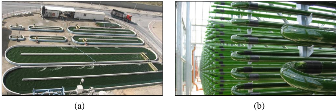
Figura 1.13. Esempi di sistema di coltivazione: (a) sistema aperto ( raceway ponds , http://algae-energy.co.uk/biofuel_production/cultivation/ ) e (b) sistema chiuso ( fotobioreattore tubolare , http://chlorelle.wordpress.com/ ).
