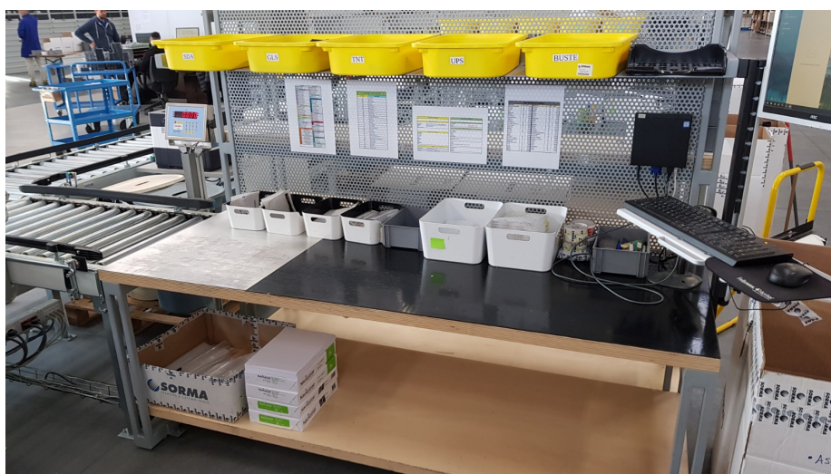
Figura 5.7: Una delle postazioni di imballaggio dopo il cantiere 5S
