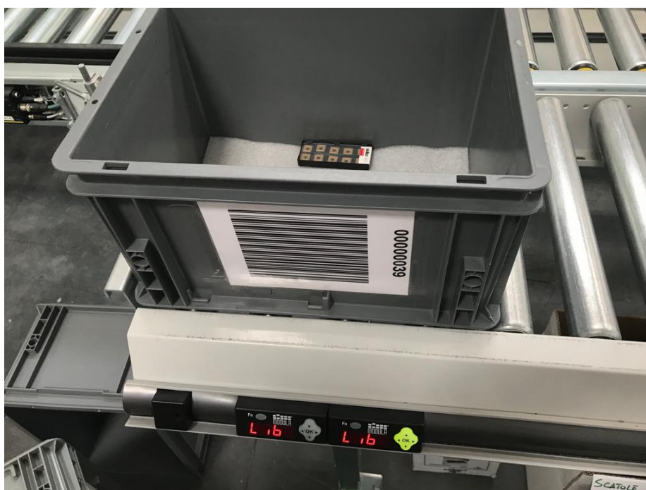
Figura 4.17: Completamento prelievo dal magazzino verticale con sistema luminoso put to light
