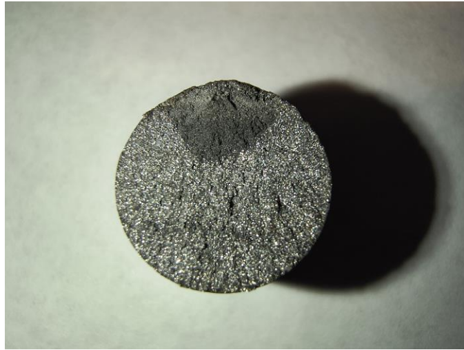
Figura 58 Superficie di frattura provino prova 6
