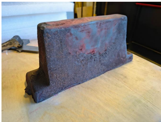
Figura 11 Provino finale a seguito di trattamento termico e post saldatura
