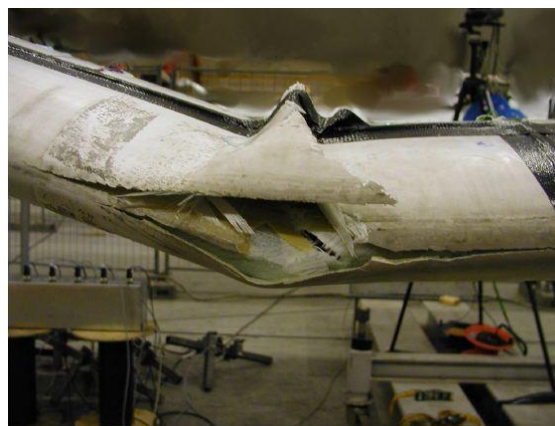
Figura 3.15 Pala portata a rottura dopo un test a flessione.
