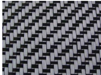
Figura 3.30 Esempio di tessuto (twill 2/2) ibrido vetro/carbonio, soluzione talvolta utilizzata nelle pale eoliche.
