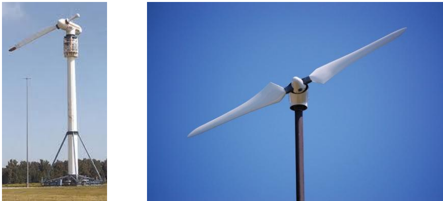
Figura 2.12 A sinistra esempio di rotore monopala con il contrappeso caratteristico; a destra un rotore bipala. La configurazione comunque più diffusa è quella tripalare.
