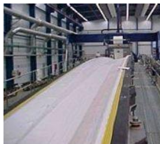
Figura 3.36 In alto a sinistra un esempio di stampo per resin infusion, con le due metà della pala realizzate separatamente e poi tramite bracci robotizzati congiunte mediante adesivi. In alto a destra e in basso un esempio del sistema robotizzato di distribuzione dei tessuti di rinforzo, per ottenere una pala dalla qualità e prestazioni più affidabili e rigorose.
