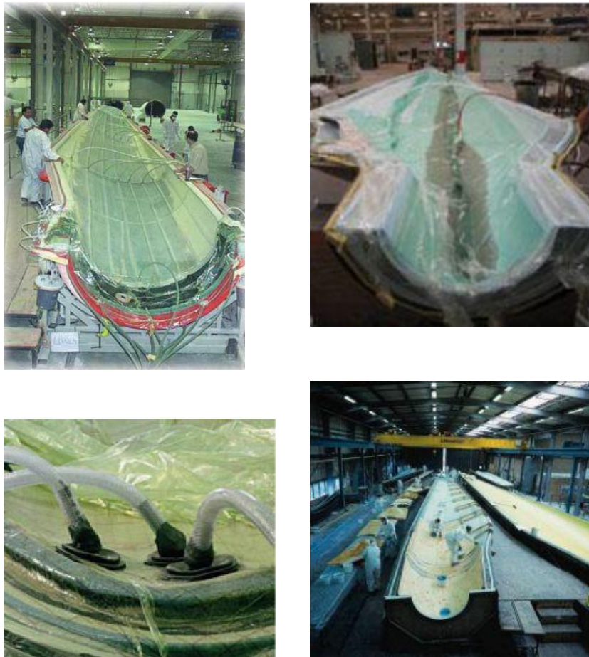
Figura 3.35 Immagini relative al processo di resin infusion. In alto la fase in cui la resina viene forzata mediante un sistema di distribuzione opportunamente progettato attraverso il rinforzo precedentemente stratificato. Sotto un dettaglio del sistema di iniezione di resina e un immagine che dà l'idea delle dimensioni delle pale che possono essere prodotte.
