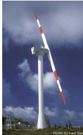
Figura 2.5 Mod-5B della Boeing. Potenza nominale 3.2 MW, rotore con 98 m di diametro.
