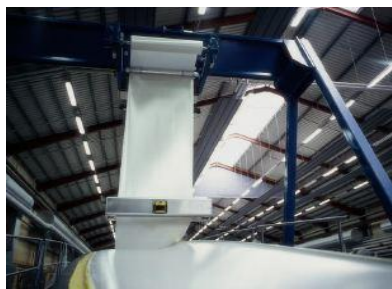
Figura 3.36 In alto a sinistra un esempio di stampo per resin infusion, con le due metà della pala realizzate separatamente e poi tramite bracci robotizzati congiunte mediante adesivi. In alto a destra e in basso un esempio del sistema robotizzato di distribuzione dei tessuti di rinforzo, per ottenere una pala dalla qualità e prestazioni più affidabili e rigorose.
