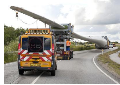
Figura 3.2 A sinistra la pala da 61.5 metri della LM Wind Power. A destra la pala da 75 metri della Siemens durante il trasporto al sito di installazione.
