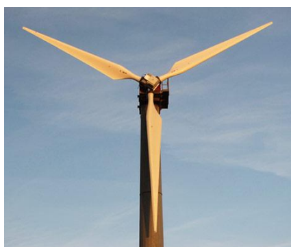
Figura 3.24 Esempio di pale eoliche realizzate interamente in legno su turbina di piccola taglia.
