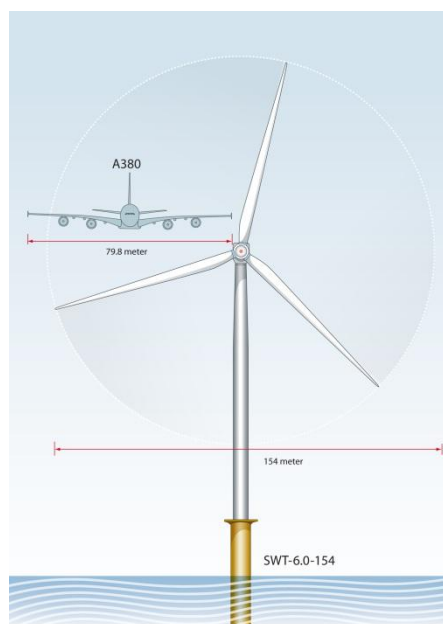
Figura 4.13 Disegno della turbina Siemens SWT-6.0-154, con il confronto tra la pala e l'apertura alare di un airbus A380.
