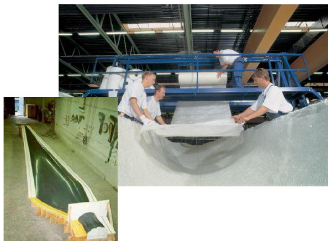
Figura 3.34 Esempio di deposizione a mano sullo stampo da parte di un gruppo di operatori di differenti strati di tessuto di rinforzo.
