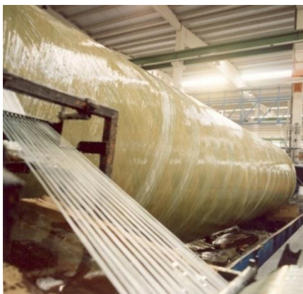
Figura 3.39 Un esempio del processo di filament winding: fibre di vetro tese e avvolte attorno al mandrino (qui per realizzare un serbatoio).
