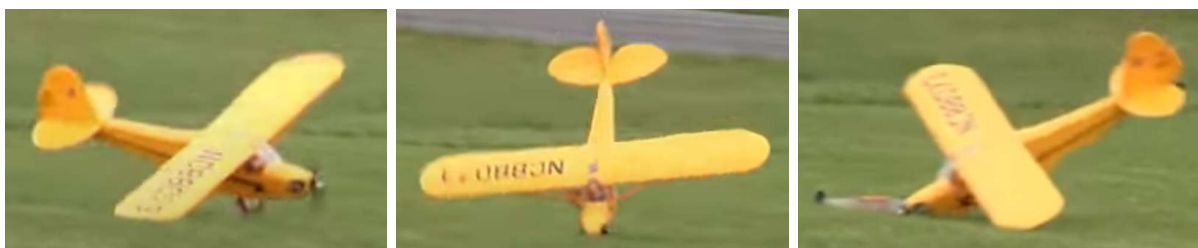
Figura 20.1: l'aereo atterra con un eccessivo rollio, e l'ala destra tocca terra assieme al carrello;
