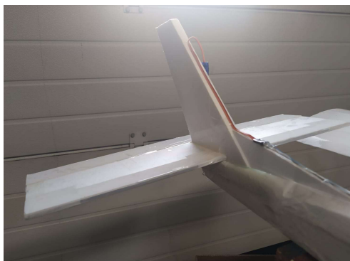
Figura 24: Nuova posizione dello stabilizzatore orizzontale: in questa configurazione, gli sforzi che il timone deve sopportare sia durante il volo sia in caso di impatto col terreno sono significativamente ridotti.
