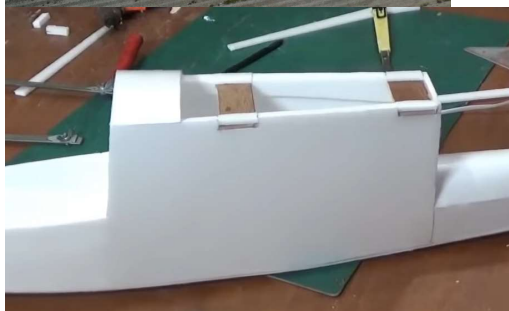
Figura 23.2: Immagine tratta dalle istruzioni originali per la costruzione dell'aereo: si noti come i supporti in legno siano stati "annegati" nella fusoliera.
