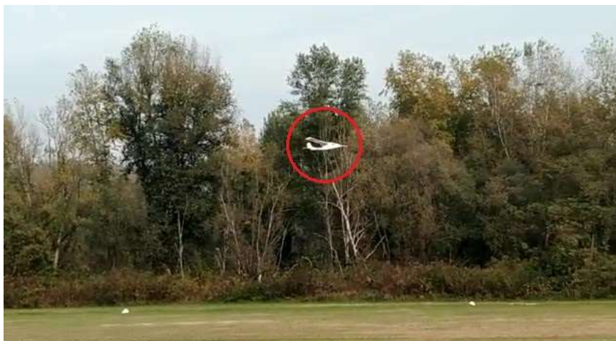
Figura 25: Aereo durante il quarto volo: è stato scelto di volare ad una quota relativamente bassa per sfruttare la protezione dal vento fornita dagli alberi.
