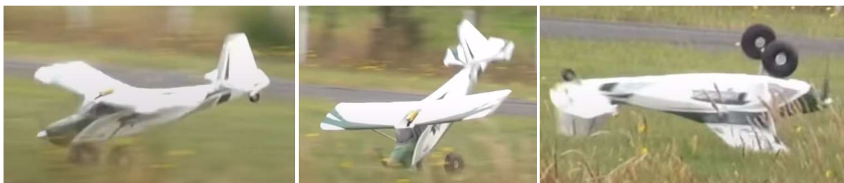
Figura 19.1: l'aereo atterra con una picchiata eccessiva: si può notare come l'elica sia pericolosamente vicina al terreno;
