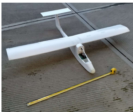
Figura 23.1: Prima versione dell'aereo: la fusoliera non è stata chiusa davanti per mostrare la posizione della scheda del pilota automatico; mancano ancora il supporto del motore e quelli diagonali dell'ala.
