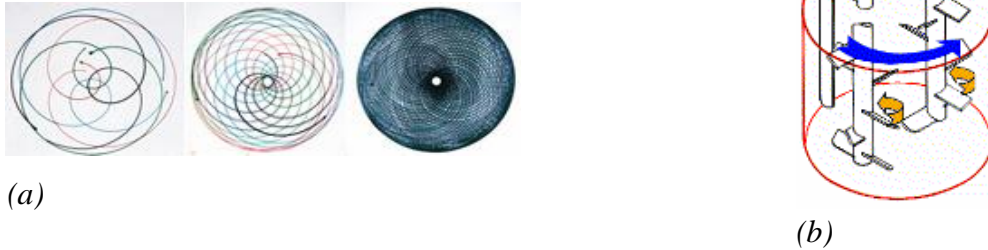
Figura 1.2 Movimento planetario (a); Miscelatore planetario a doppio braccio (b).
