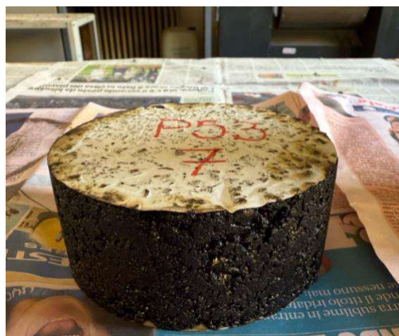
Figura 5: Esempio provino ottenuto con il compattatore giratorio
