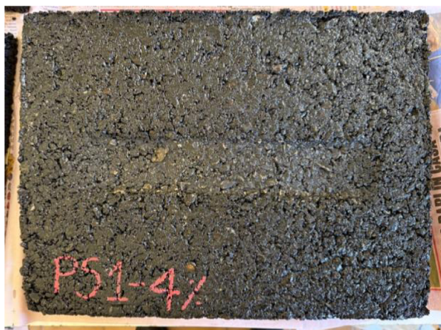
Figura 36: Lastra PS a seguito della prova WT
