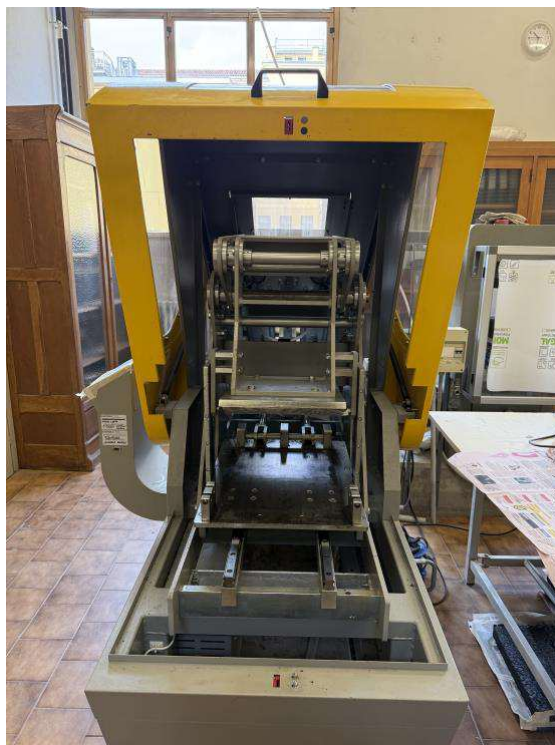
Figura 11: Compattatore a rullo presente presso il laboratorio dell'Università di Padova
