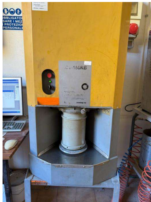
Figura 4: Compattatore giratorio presente presso il laboratorio dell'Università di Padova
