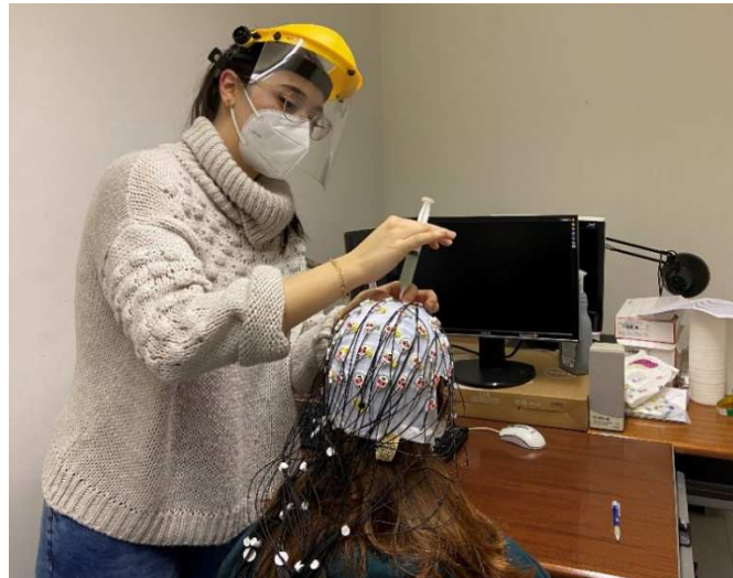
Figura 3.2: Momento in cui veniva inserito il gel all'interno degli elettrodi per ridurre l'impedenza cutanea.
