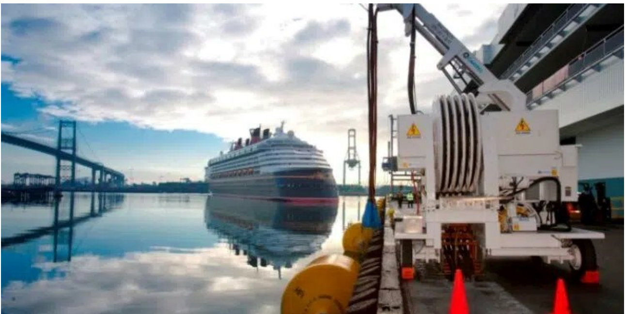
Figura 3-3: carro semovente per connessione alla banchina - fonte:(cittafuture.quotidiano.net)
