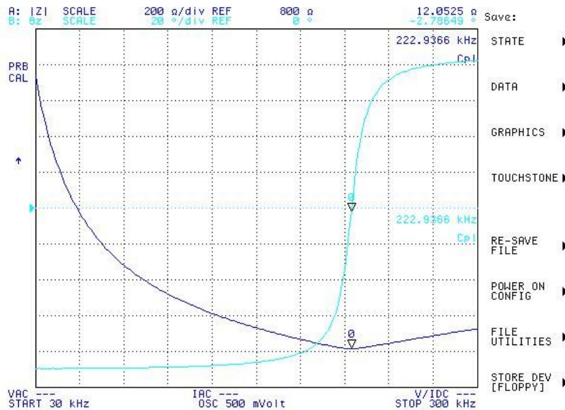
Figura35: evidenzio la frequenza di risonanza serie del tank, EFD25.
