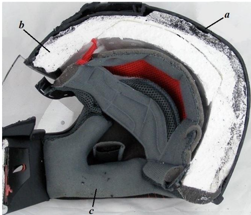
Figura 2.17: Sezione di un casco da moto in cui sono identificabili la calotta esterna (a), il rivestimento interno (b) e l'imbottitura (c) [26].
