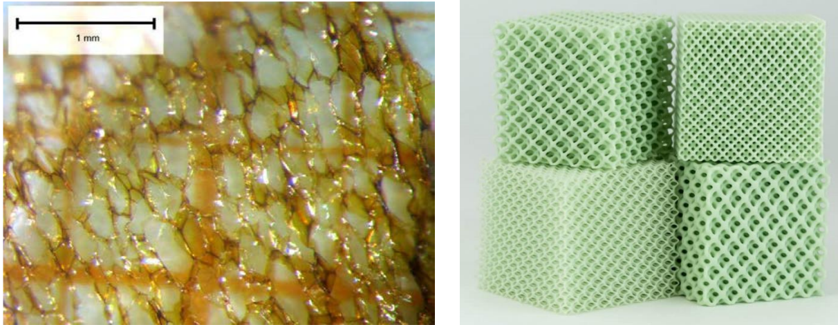
Figura 3.35: Confronto tra un'immagine ricavata tramite microscopio di una schiuma in polistirene espanso dove è possibile vedere la randomicità nelle dimensioni delle celle e l'anisotropia della schiuma [55] e alcuni esempi di campioni di strutture reticolari [63].
