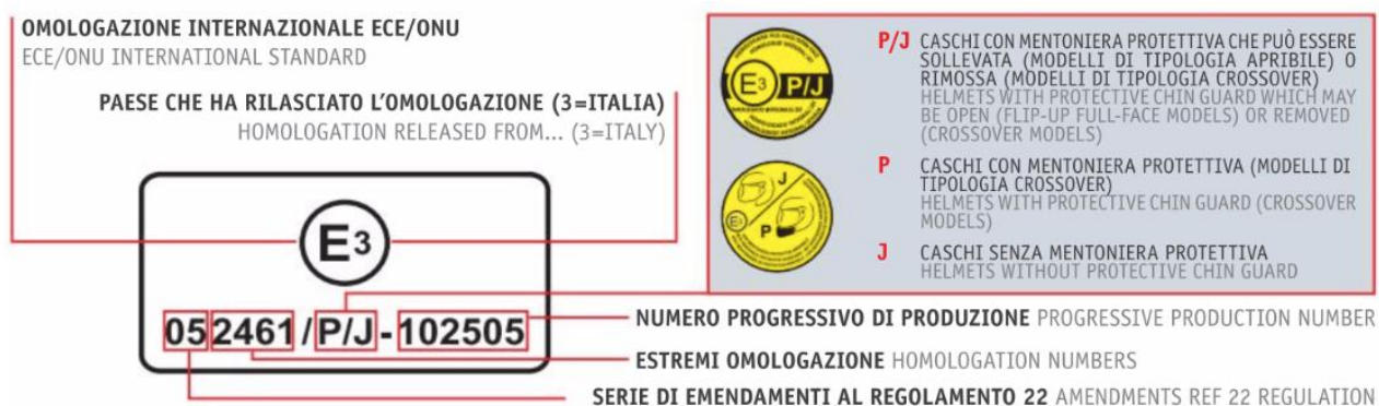
Figura 2.7: Schema della sigla di omologazione [16].
