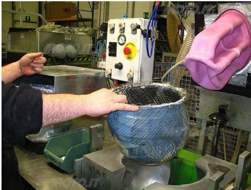
Figura 3.22: Estrazione di un casco in composito dal suo stampo, si nota la parte in eccesso che successivamente verrà rimossa [48].
