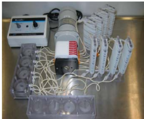
Figura 3.5 Bioreattore con pompa peristaltica per la movimentazione del medium e sezione di scambio gas.
